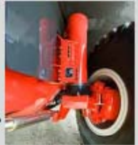
RD 500 Sospensione a ritardatore RD 500 Front susp. cylinder
