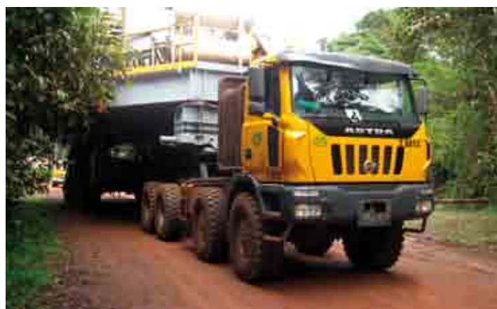
8x8 tracteur boîte 16S221 et WSK440 avec refroidissement supplémentaire 8x8 tractor cambio 16S221 y WSK440 con enfriamiento adicional
