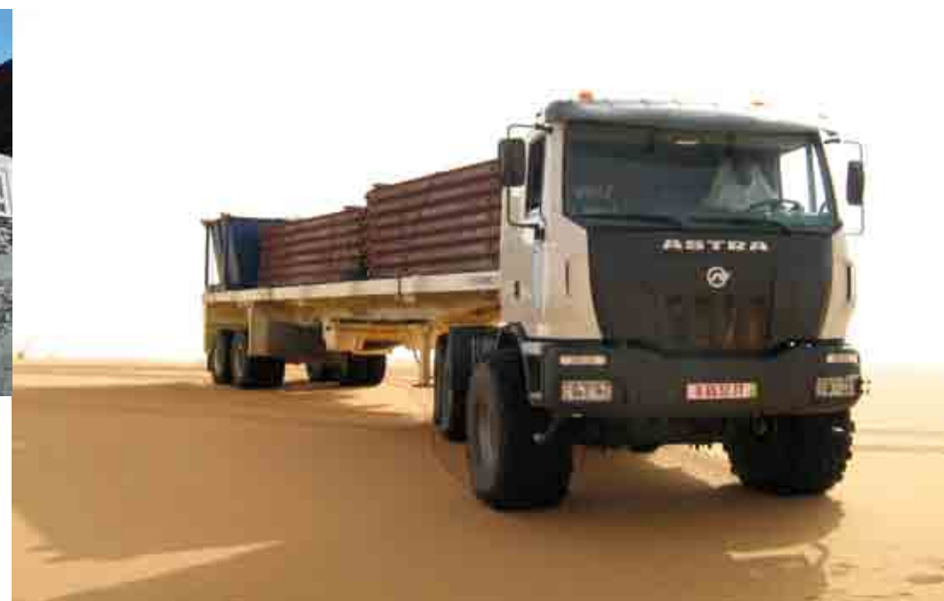
6x6 Tracteurs version désert avec pneus de sable 24.00 R20.5 6x6 Tractor versión desierto con neumáticos arena 24.00 R20.5
