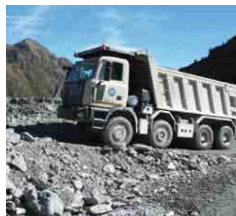
8x6 Boîte automatique ALLISON avec retardateur et filtre supplémentaire antiparticules 8x6 Cambio automático ALLISON con ralentizador y filtro adicional antipartículas
