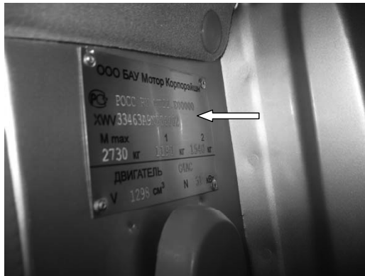
Рис. 1.6.1. Расположение заводской таблички на стойке кабины
