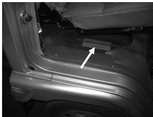
Рис.1.6.2 Расположение идентификационного номера автомобиля на панели кабины
