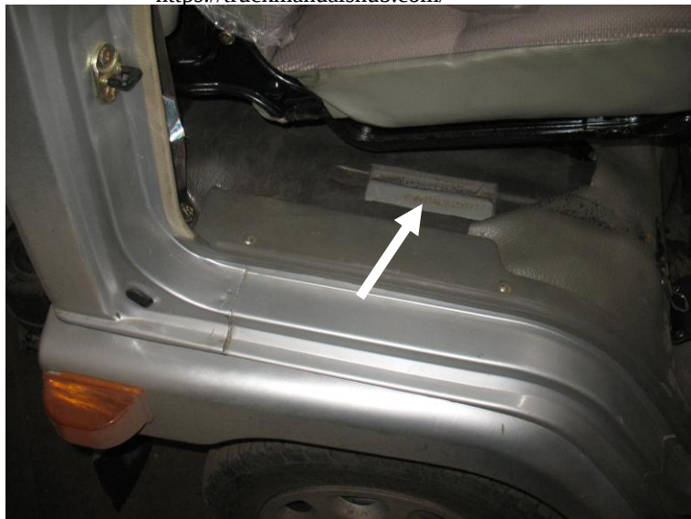
Рис.1.6.2 Расположение идентификационного номера автомобиля на панели кабины
