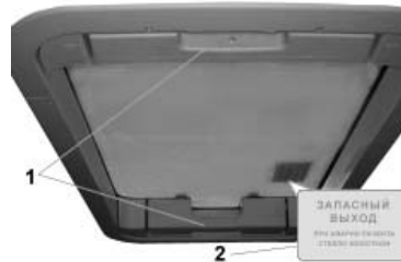
Рис. 3.30. Люк крыши: 1 -ручки; 2 -инструкционная табличка
