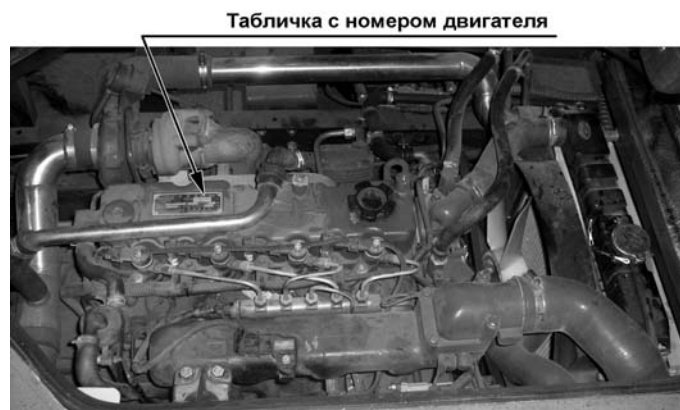
Рис. 1.2. Расположение фирменной таблички двигателя
