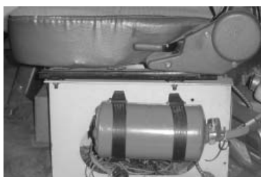
Рис. 3.32. Расположение огнетушителя под сиденьем водителя
