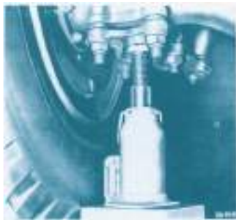
Положение домкрата—задний мост(1926A)
