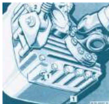
Раздаточная коробка VG2000-3W: 1. сливная пробка; 2. заливная пробка
