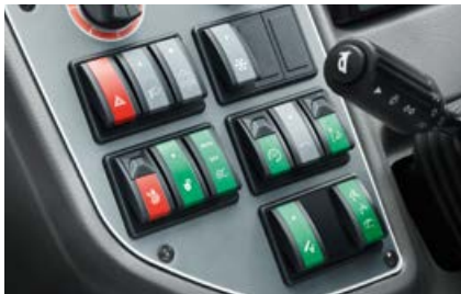
Een zeer overzichtelijke werkplek Groen: hydrauliekfuncties Blauw: rijfuncties Grijs: elektrische functies Rood: veiligheid
