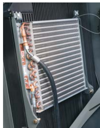
Onder de motorkap geplaatste koelpakket is gemakkelijk bereikbaar.
