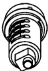
Установка цилиндра в корпус ручки 4576
