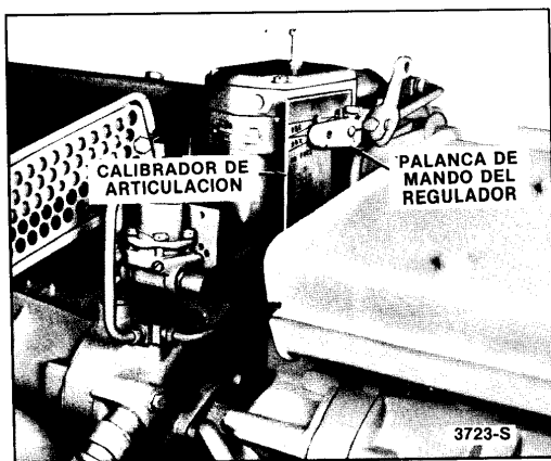
Fig. 7 - Colocación de la palanca de mando del regulador
