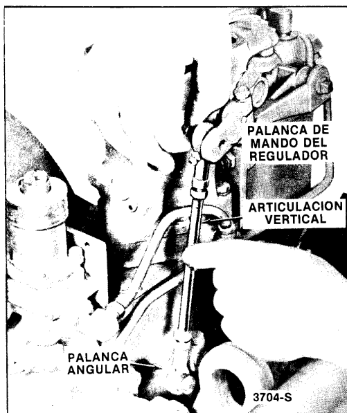
Fig. 6 - Ajuste de la articulación vertical
