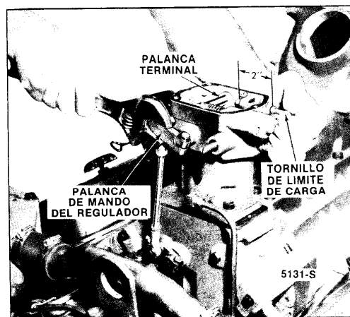
Fig. 7 - Ajuste del tornillo de límite de carga
