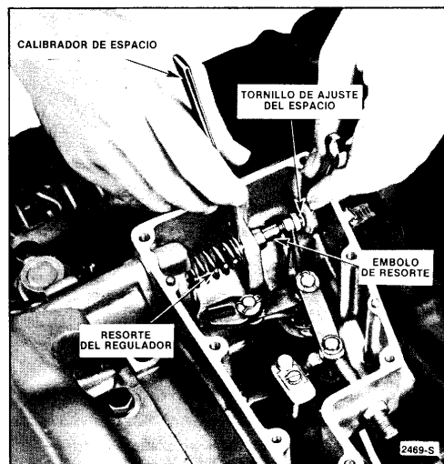
Fig. 1 - Ajuste del espacio del regulador
