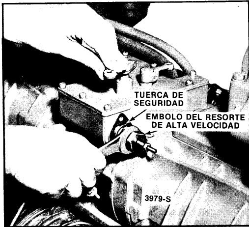
Fig. 6 - Ajuste de la velocidad máxima sin carga
