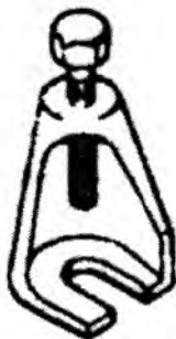
Съемник для отделения пальцев рулевых наконечников от рычага поворотного кулака
