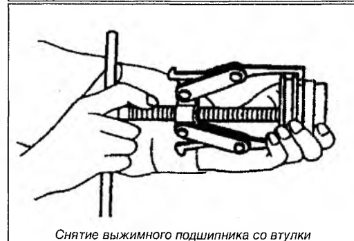
Снятие выжимного подшипника со втулки
