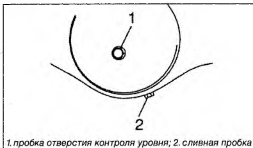
1. пробка отверстия контроля уровня; 2. сливная пробка
