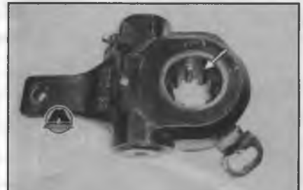
Рис. 2 (червячное колесо с внутренними шлицами).
