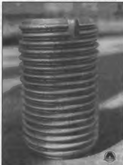
Фото 1. Присоединительная резьба (M24x2) штуцера в корпус крышки масляного фильтра.
