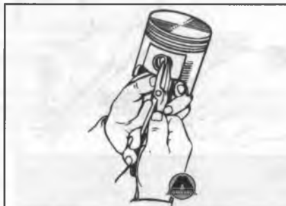
Рис. 10.6.1. Снятие (установка) стопорного кольца поршневого пальца.
