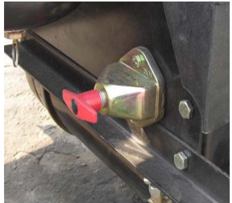
Interruptor mecánico de la batería (posición encendido)
