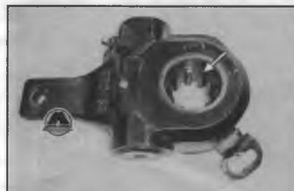
Рис. 2 (червячное колесо с внутренними шлицами).
