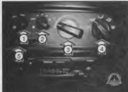
1. Выключатель вентиляции; 2. Ручка открывания створок вентилятора; 3. Ручка регулятор подогрева воздуха; 4. Ручка регулирования направления потока воздуха; 5. Ручка открытия доступа наружного воздуха; 6. Выключатель вспомогательного вентилирования.
