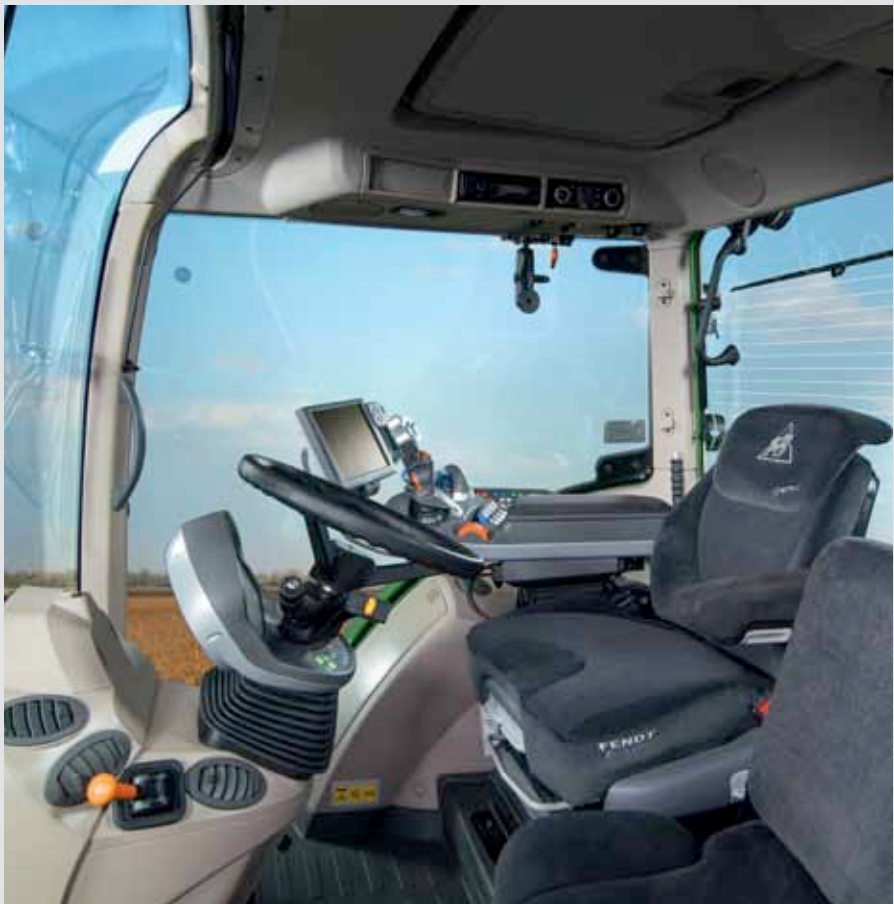
Die Sicht vom Fahrerplatz des 700 Vario ist einmalig. Durch die großen Glasflächen, unter anderem begründet durch das Wegfallen der B-Säule auf der rechten Seite, ist das Raumgefühl enorm.
