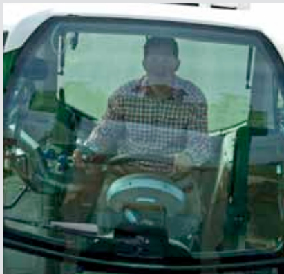
Zu öffnende Frontscheibe mit Türen links und rechts (optional).
