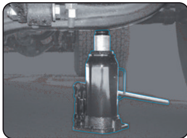
Установка домкрата под передний мост
