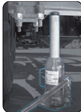
Установка домкрата под задний мост
