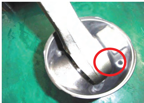
Рис. 3. Предварительная установка шатунной группы поршня
