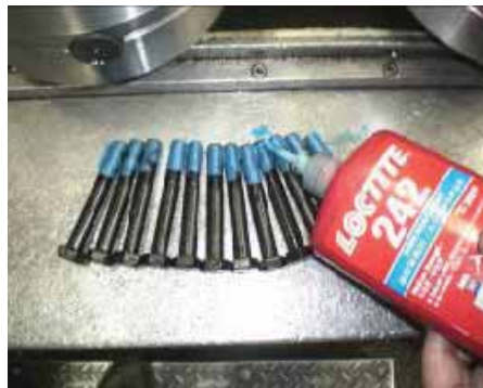
(6) Смажьте резьбы герметиком
