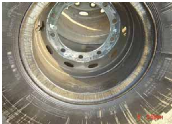
Рис. 2-11 Утечки через песчаные раковины
