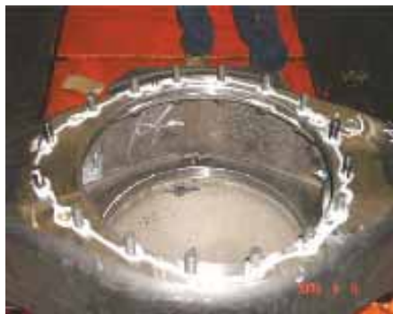
Процедура 11: Установка главной передачи
