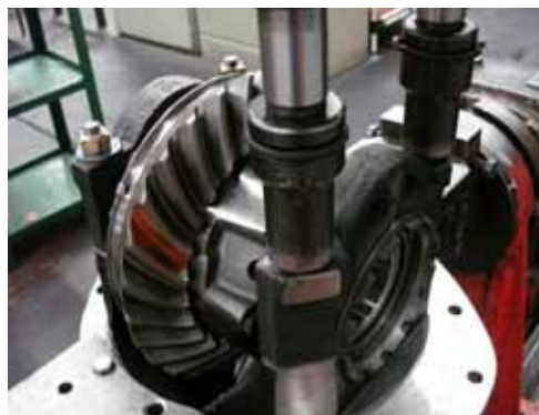
(12) Затяните гайки крышки до момента 210~260 Н•м.
