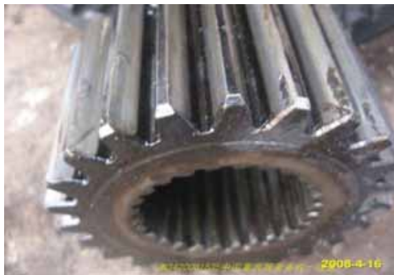
Рис. 2-23 Загрязнения в колесном редукторе, вызывающие повышенный износ солнечной шестерни
