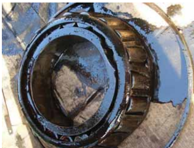
Рис. 2-22 Деформация сепаратора подшипника
