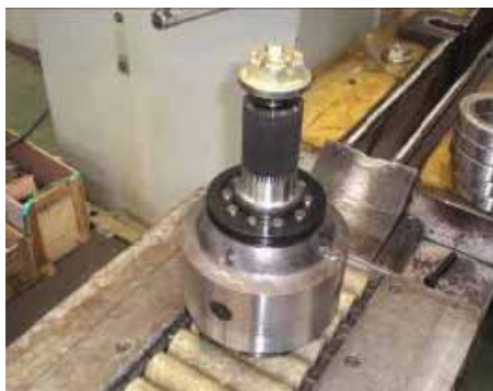
(8) Установите кольцо со штифтами блокировки дифференциала
