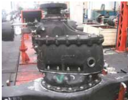
Процедура 11: Установка главной передачи
