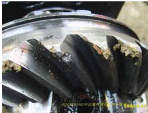
Рис. 2-27 Излом зубьев конического зубчатого колеса
