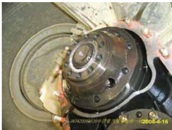
Рис. 2-30 Излом деталей на входе в межосевой дифференциал
