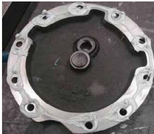
Рис. 2-2 Нанесение герметика на концевую крышку колеса
