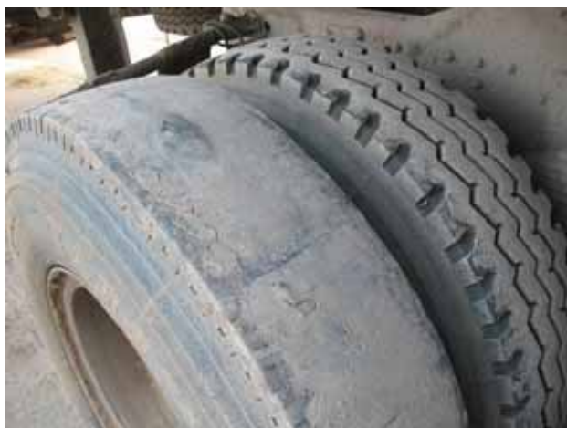
Рис. 2-24 Несимметричный износ шин вследствие деформации картера моста
