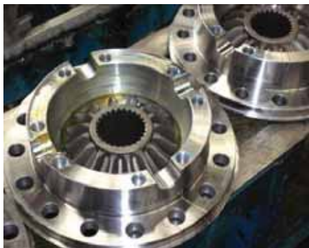
(3) Установите шестерню полуоси
