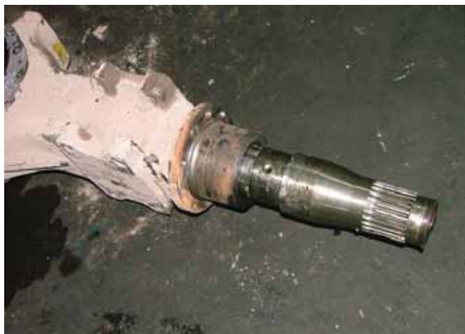
Рис. 2-13 Биения головки литого корпуса трехсекционного моста
