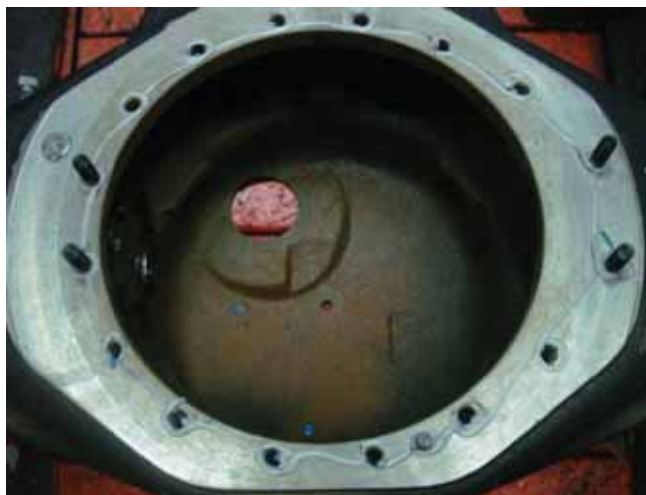
Рис. 2-17 Нанесение герметика на контактную поверхность картера моста
