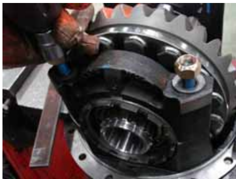
(9) С помощью пневматического гайковерта (B16) затяните гайки, чтобы создать предварительную нагрузку.
