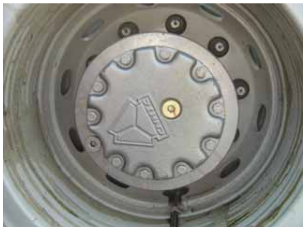
Рис. 2-12 Утечки через песчаные раковины
