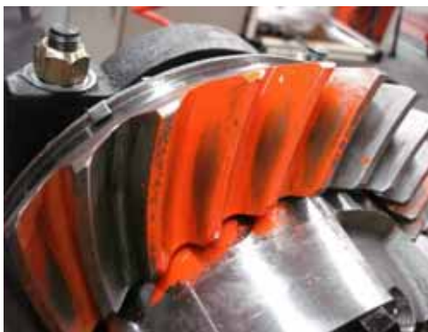
(11) Обеспечьте правильное положение пятен контакта зубьев, согласно техническим требованиям.
