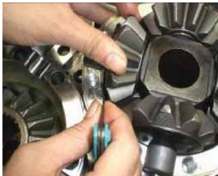
(5) Проверьте зазор (от 0,6 до 1,0 мм)
