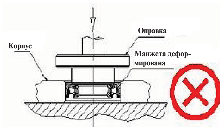
Рис. 2-8 Внутренний диаметр оправки слишком мал
