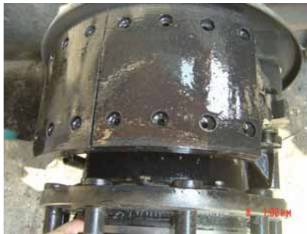
Рис. 2-33 Масляное пятно на тормозной накладке
