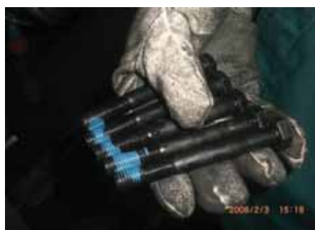
(4) Смажьте резьбы герметиком
