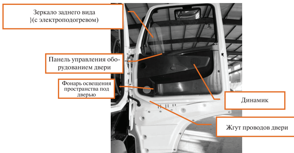
Рисунок 8-36 Состав компонентов электрооборудования двери автомобиля
