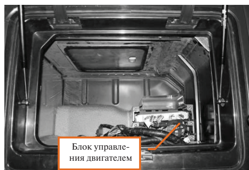
Рисунок 8-50 Схема установки показанного на рисунке 8-51 блока управления двигателем
