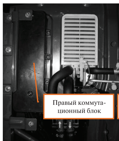
Рисунок 8-48 Правый коммутационный блок кабины
