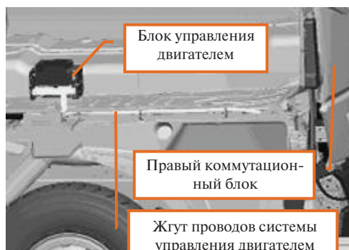
Рисунок 8-51 Схема установки жгута проводов системы управления двигателем
