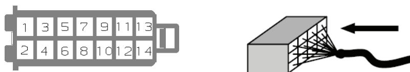
Рисунок 6 - 81 Схема расположения разъемов комбинации приборов
