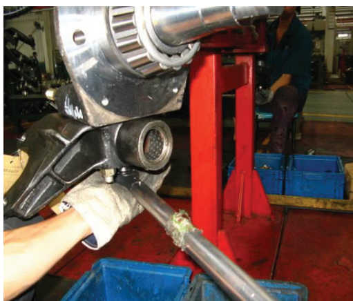
Рис. 2-11 Контроль момента затяжки самоконтрящейся гайки
