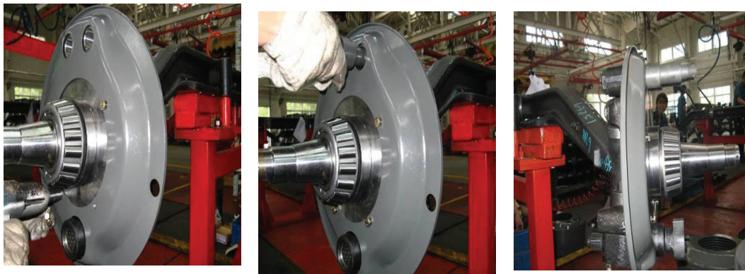
Рис. 2-13 Регулировка угла поворота колеса
