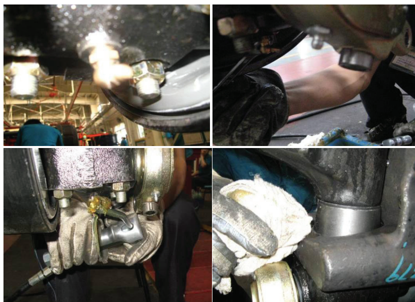
Рис. 2-19 Нагнетание смазки и протирка компонентов моста.
