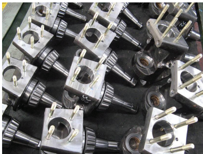
Рис. 2-1 Подшипник ступицы, установленный на поворотном кулаке.
