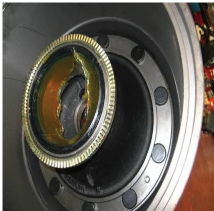
Рис. 2-2. Сборка передней ступицы со ступицей тормозного механизма
