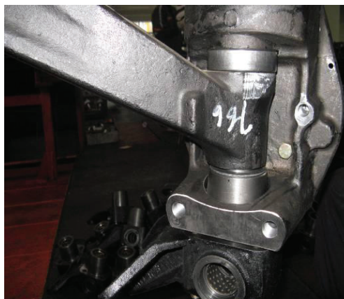
Рис. 2-12 Проверка зазора при установке поворотного кулака
