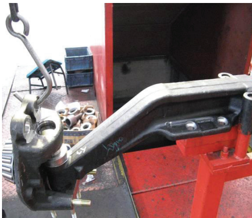
Рис. 2-7 Установка поворотного кулака
