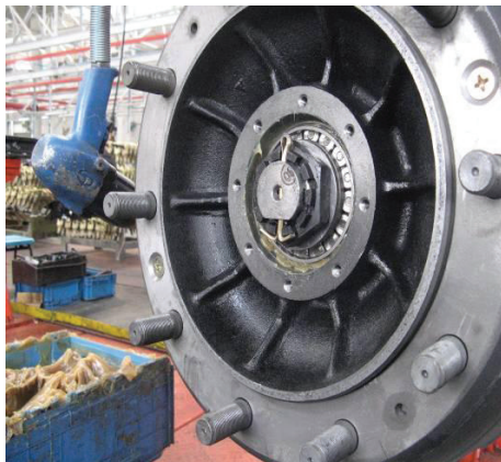
Рис. 2-3. Установка уплотнительной манжеты и зубчатого колеса системы ABS
