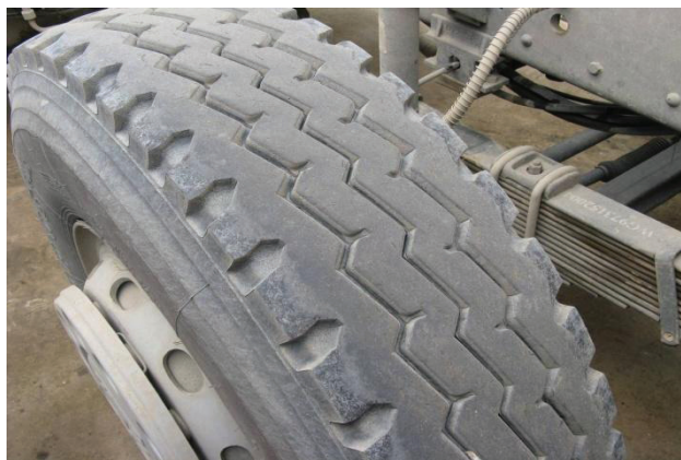
Рис. 4-1 Отклонение переднего колеса от требуемого положения
