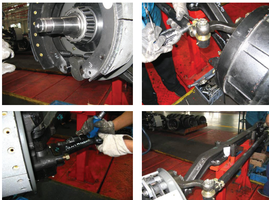
Рис. 2-15 Установите рулевую тягу в сборе и поворотный кулак
