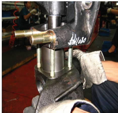
Рис. 2-10 Установка кулака на кронштейн
