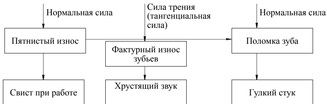
Рис. 5-3 Процесс износа зубьев при нормальной эксплуатации
