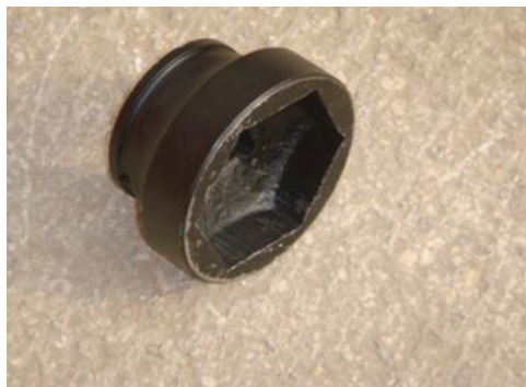
Рис. 14а: Головка для отворачивания/затяжки гайки фланца
