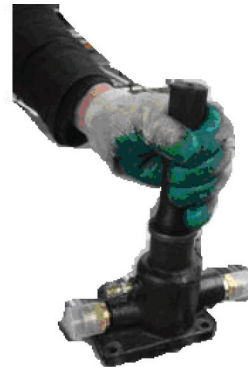
Рис. 13б: Использование оправки для установки наружной уплотнительной манжеты торцевой крышки малого картера
