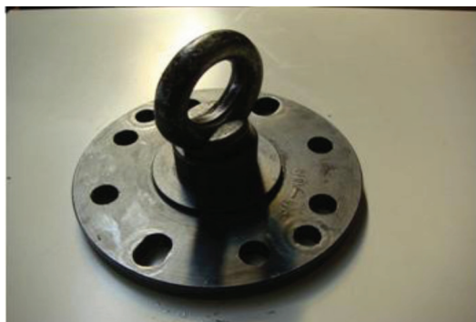
Рис. 2а: Подвес дополнительного планетарного механизма коробки передач
