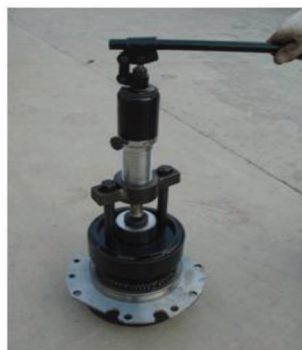
Рис. 4б: Используйте съемник для снятия конусной ступицы синхронизатора или зубчатой муфты синхронизатора.
