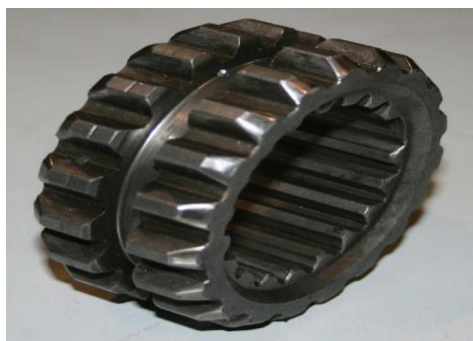
Рис. 5-11. Зубчатая втулка основного вала
