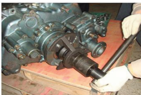
Рис. 1б: Снятие/установка центральной гайки выходного вала при помощи специального ключа
