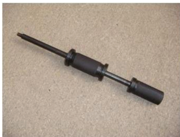
Рис. 6а: Съёмник оси паразитной шестерни.
