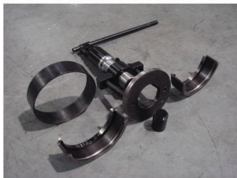
Рис. 4а: Съемник конусной ступицы синхронизатора высшей передачи
