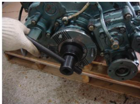
Рис. 14б: Использование головки для гайки фланца совместно с рычагом
