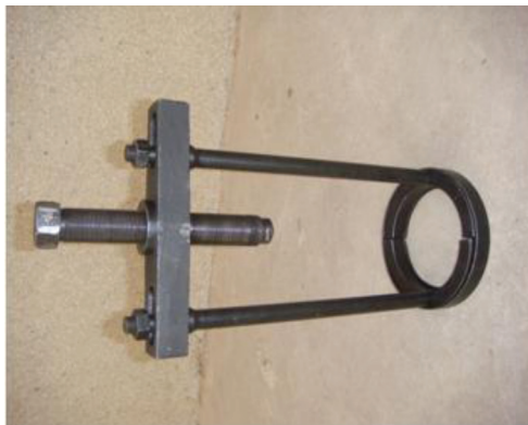
Рис. 8а: Съемник подшипника входного вала
