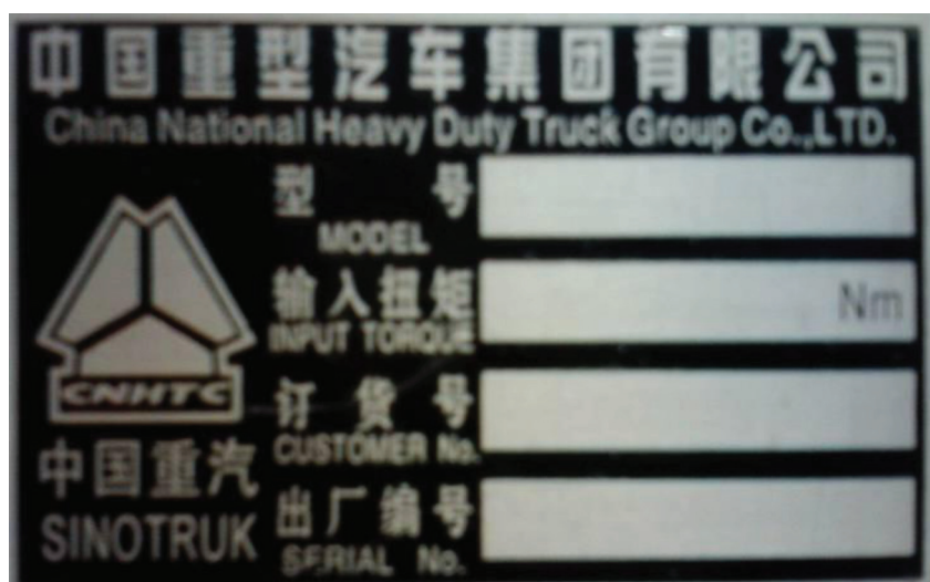
Рис. 2-5: Идентификационная табличка коробок передач серии HW
