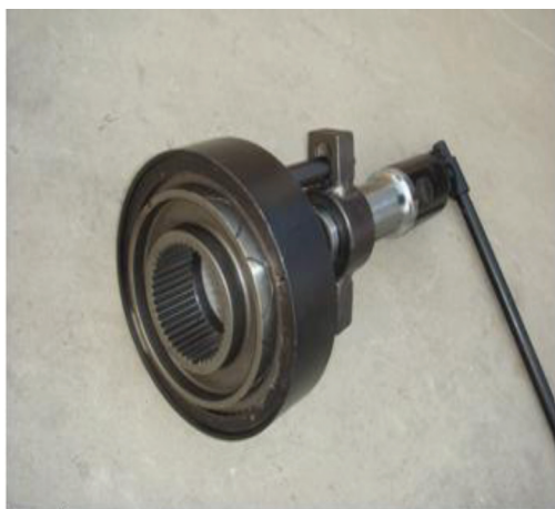
Рис. 4с: Снятая конусная ступица синхронизатора высшей передачи
