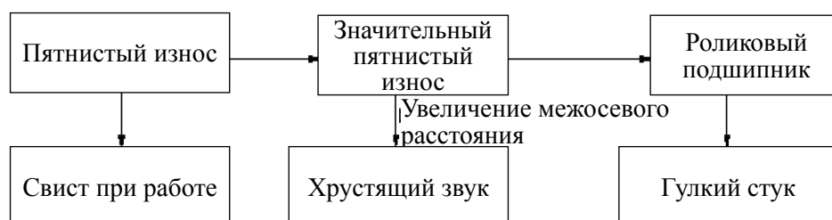
Рис. 5-6. Процесс износа подшипников
