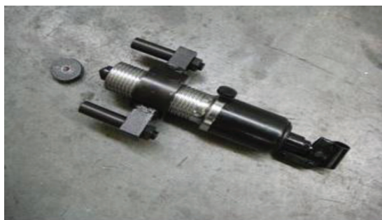
Рис. 16а: Съемник фланца
