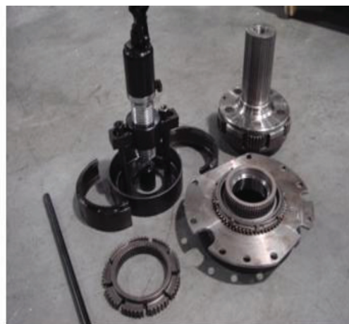
Рис. 4д: Снятая зубчатая муфта синхронизатора
