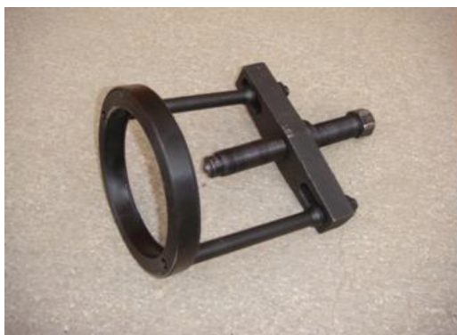
Рис. 3а: Съемник подшипника водила планетарной передачи
