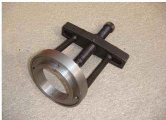
Рис. 5а: Съёмник подшипников промежуточных валов
