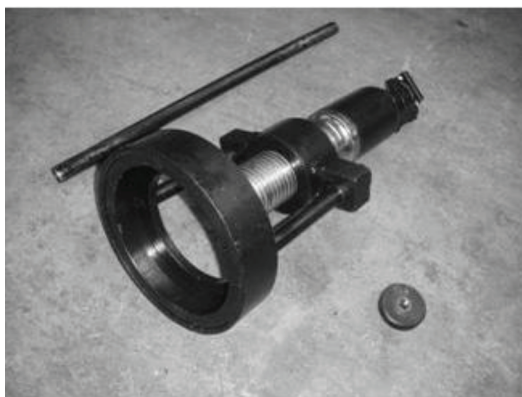
Рис. 17а: Съемник подшипника выходного вала.
