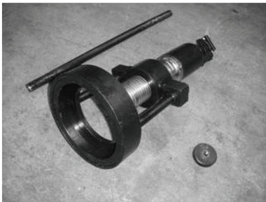
Рис. 17а: Съемник подшипника выходного вала.
