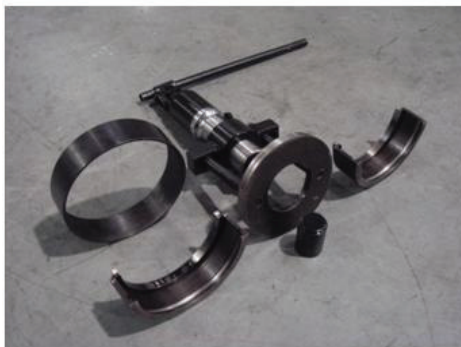
Рис. 4а: Съемник конусной ступицы синхронизатора высшей передачи
