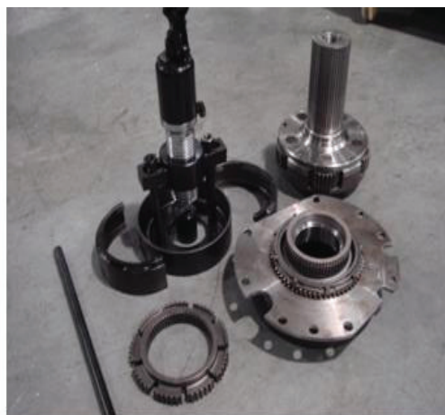
Рис. 4д: Снятая зубчатая муфта синхронизатора
