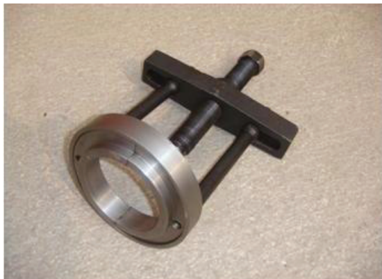
Рис. 5а: Съемник подшипников промежуточных валов
