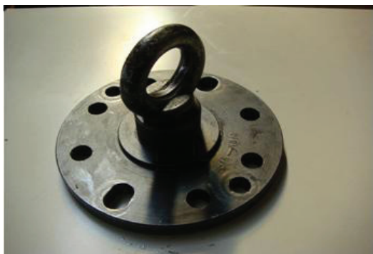
Рис. 2а: Подвес дополнительного планетарного механизма коробки передач
