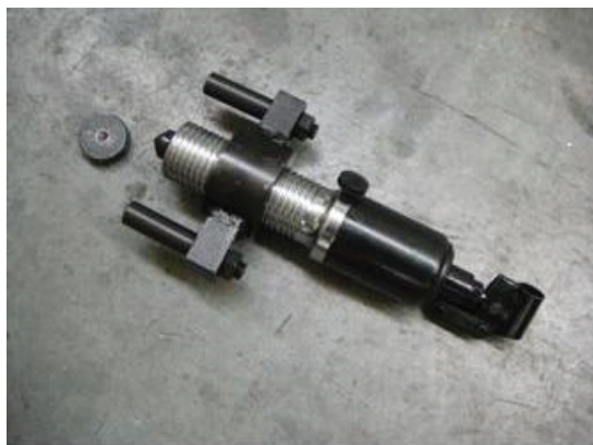
Рис. 16а: Съёмник фланца
