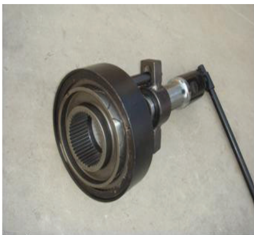
Рис. 4с: Снятая конусная ступица синхронизатора высшей передачи
