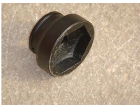
Рис. 14а: Головка для отворачивания/затяжки гайки фланца
