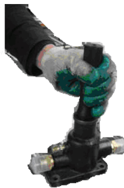
Рис. 13b: Использование оправки для установки наружной уплотнительной манжеты торцевой крышки малого картера
