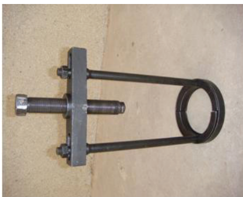
Рис. 8а: Съемник подшипника входного вала
