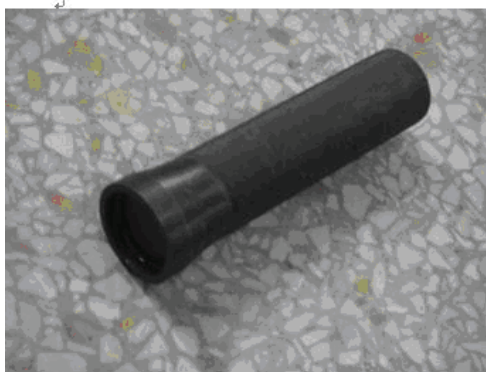
Рис. 13а: Оправка для установки уплотнительных манжет торцевой крышки малого картера
