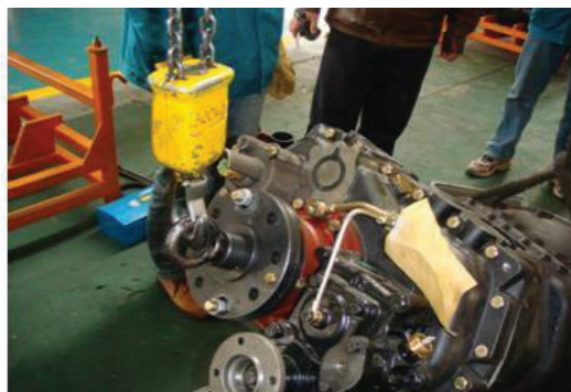
Рис. 2б: Подъем коробки передач при помощи подвеса.
