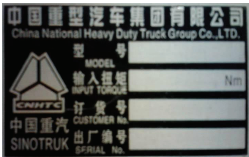
Рис. 2-6: Идентификационная табличка коробок передач серии HW
