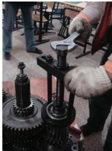
Рис. 5б: Снятие переднего и заднего подшипника с помощью съемника.
