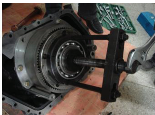
Рис. 3б: Снятие подшипника валида планетарной передачи при помощи съемника
