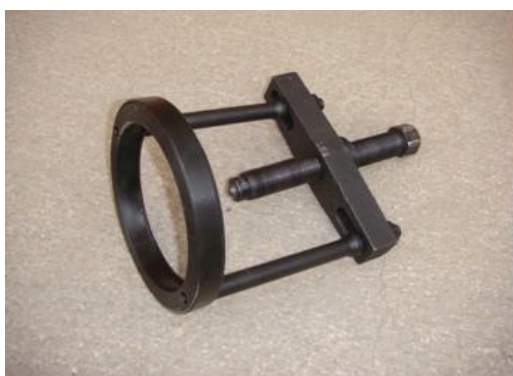
Рис. 3а: Съемник подшипника валида планетарной передачи
