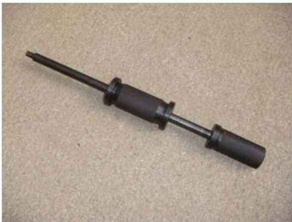
Рис. 6а: Съемник оси паразитной шестерни.
