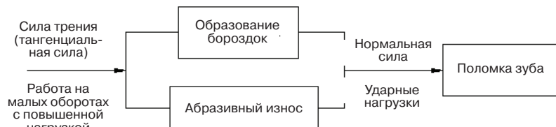
Рис. 5-4. Критический износ шестерен
