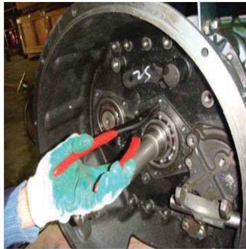
Рис. 7б: Снятие и установка стопорных колец при помощи специальных щипцов
