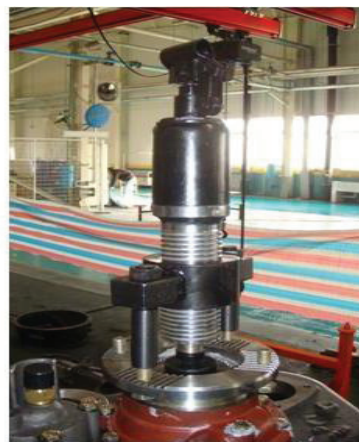
Рис. 16b: Снятие фланца при помощи съёмника.
