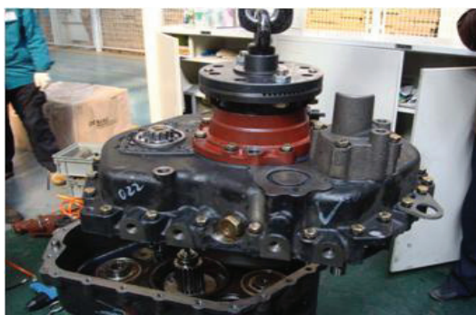
Рис. 2с: Снятие и подъем дополнительного механизма коробки передач при помощи подвеса.
