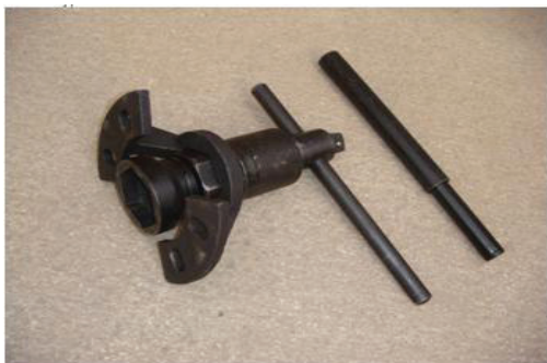
Рис. 1а: Специальный ключ для отворачивания (затяжки) центральной гайки фланца
