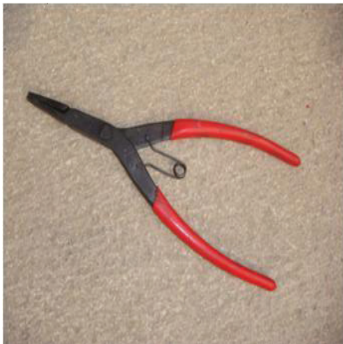
Рис. 7а: Специальные щипцы для снятия и установки стопорных колец
