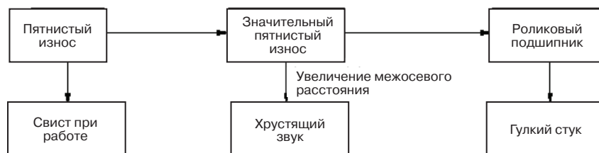
Рис. 5-6. Процесс износа подшипников
