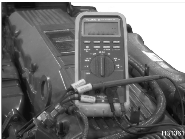
Figura 373 Medición de resistencia a la tierra del chasis
