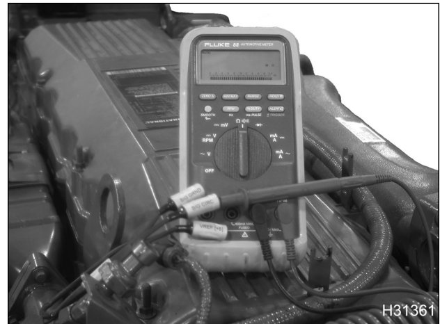
Figura 372 Medición de resistencia a la tierra del ECM en el chasis
