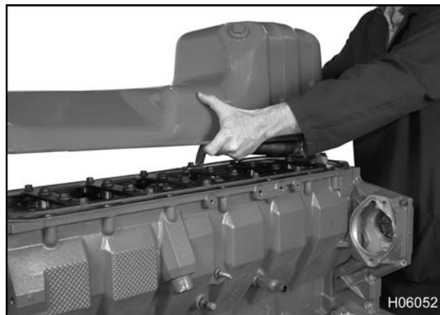
Figura 263 Retiro del cárter
