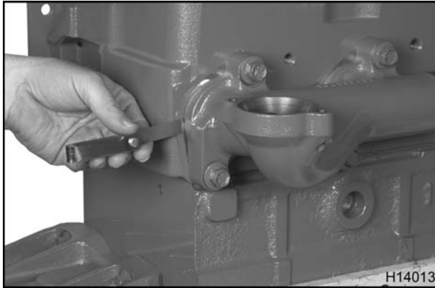
Figura 74 Inspección del múltiple de escape en busca de grietas y pandeo
