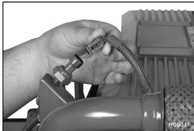
Figura 485 Conexión al EBP
