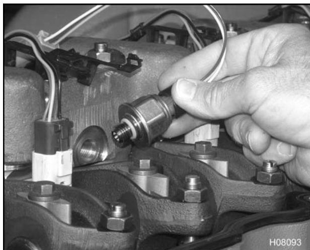
Figura 589 ICP con sello anular
