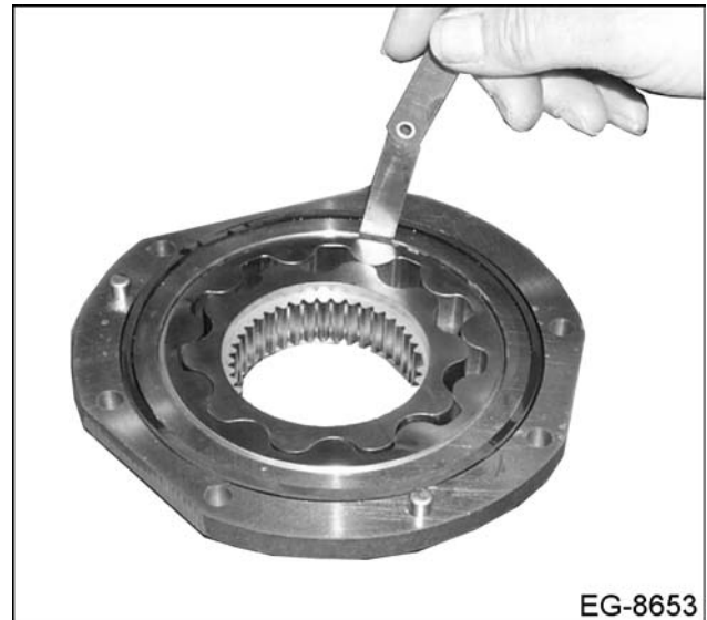
Figura 222 Juego lateral del engranaje exterior de la bomba de aceite
