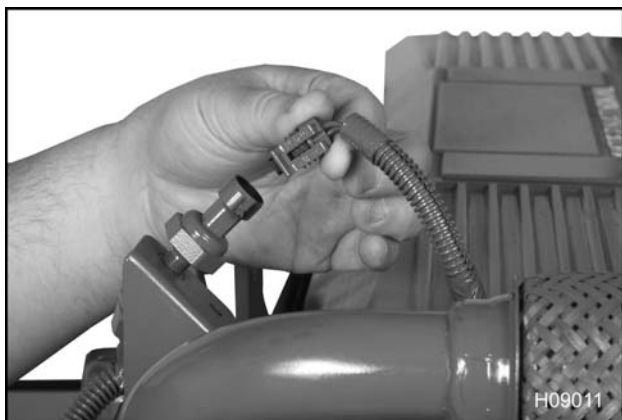
Figura 422 Desconexión del EBP
