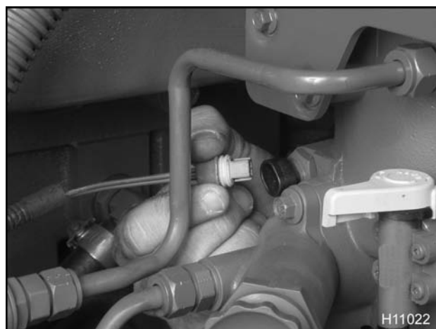
Figura 432 Desconexión del WIF
