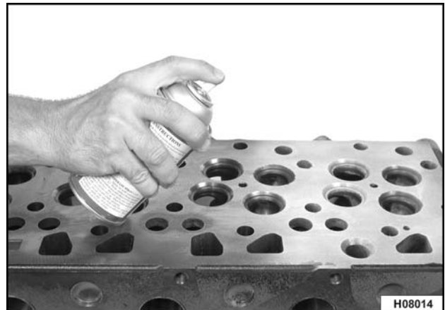
Figura 136 Rocíe revelador en la culata
