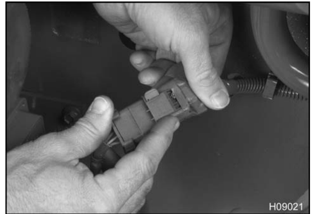
Figura 488 Conexión al cableado del VGT
