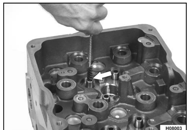
Figura 141 Limpieza de las guías de válvula
