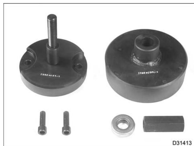
Figura 615 Instalador del sello trasero, ZTSE4637
