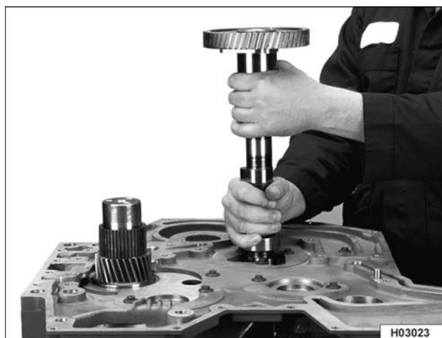
Figura 340 Retiro del conjunto del árbol de levas
