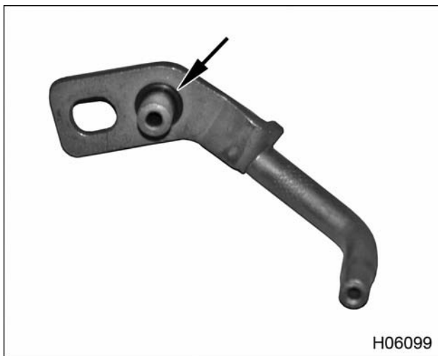
Figura 325 Sello anular (por debajo) del tubo enfriador de pistón
