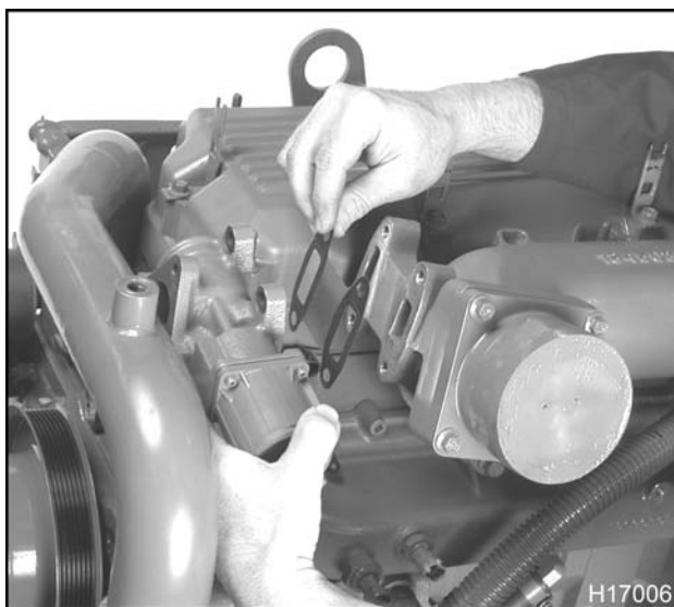
Figura 108 Empaquetadura de la válvula de EGR en el conducto mezclador de gases de escape
