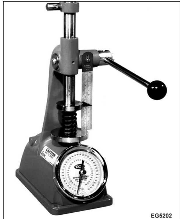
Figura 165 Medición de la tensión del resorte
