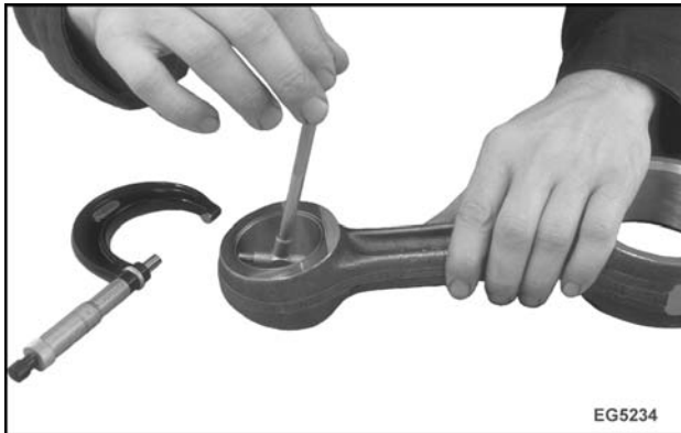
Figura 290 Medición del diámetro interior del buje para el pasador del pistón
