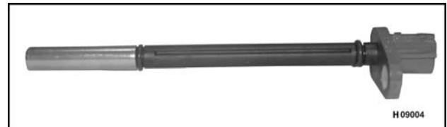
Figura 408 Sensor de posición del cigüeñal (CKP)
