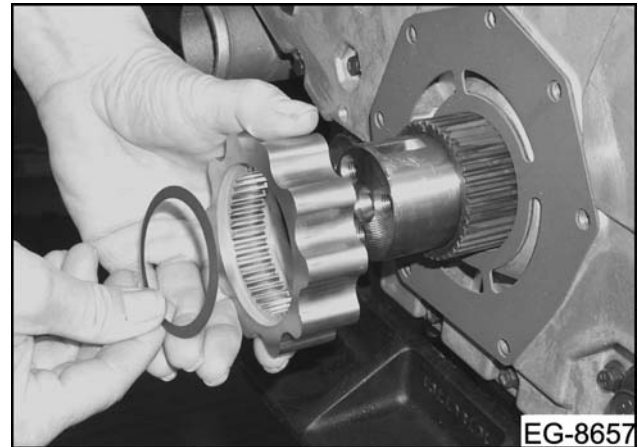
Figura 211 Arandela selladora y rotor interno
