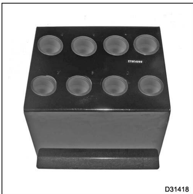
Figura 620 Soporte portainyectores – ZTSE4299B y recipientes portainyectores – ZTSE4645
