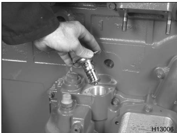
Figura 384 Retiro de la válvula térmica de aceite
