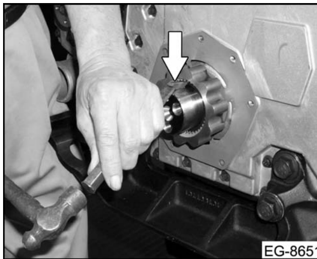
Figura 210 Retiro de la clavija del amortiguador de vibraciones
