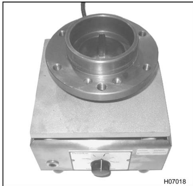
Figura 239 Caliente el amortiguador de vibraciones
