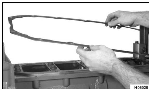
Figura 265 Retiro de la empaquetadura del cárter
