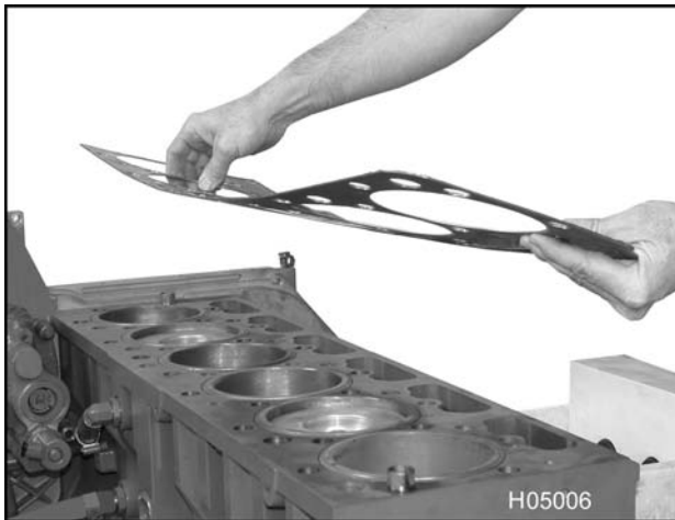
Figura 124 Retiro de la empaquetadura de la culata
