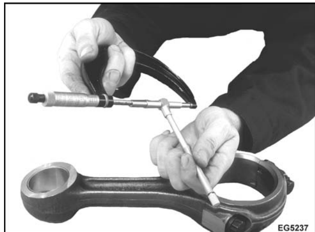
Figura 292 Medición de la conicidad de la cavidad para el cojinete
