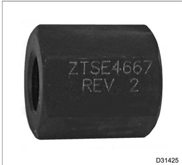
Figura 627 Medidor de roscas para pernos de la culata, ZTSE4667
