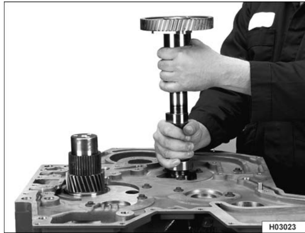
Figura 351 Instalación del conjunto del árbol de levas
