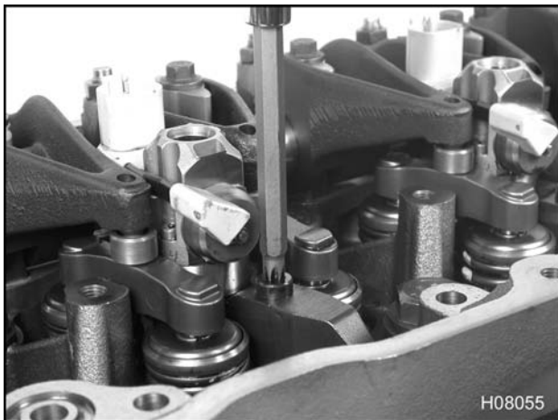
Figura 518 Instalación del sujetador
