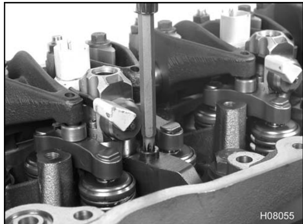
Figura 511 Retiro del sujetador y del inyector
