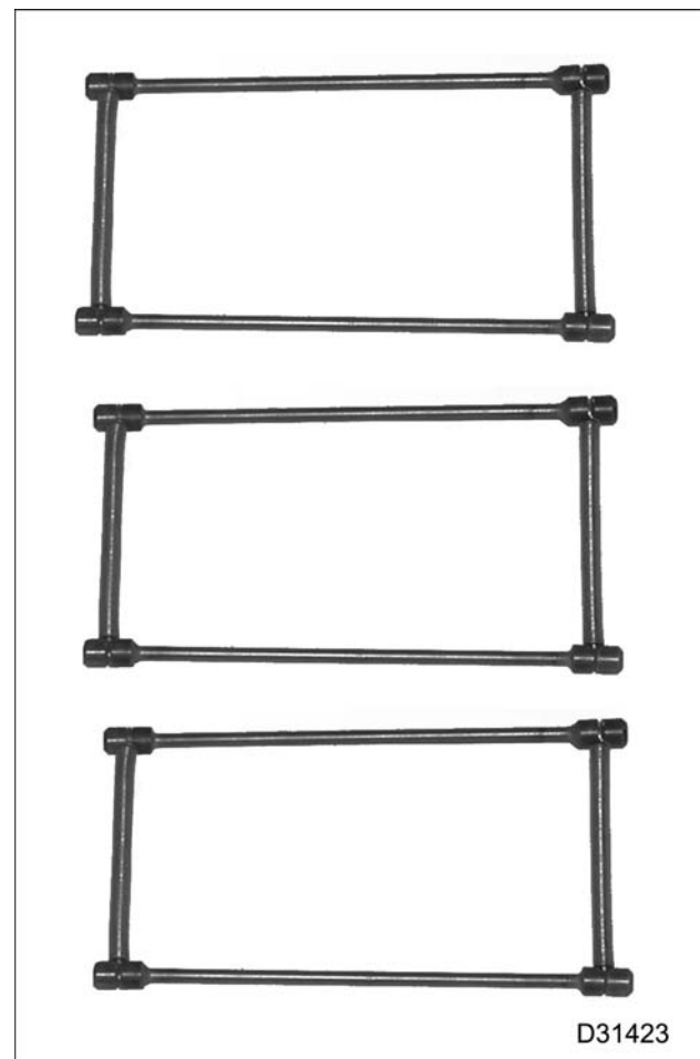
Figura 625 Espigas calibradas (juego de tres) para anillos de pistón, ZTSE4653
