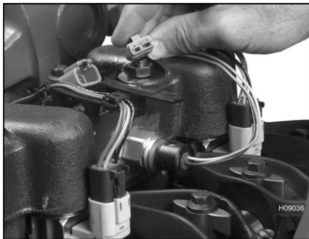
Figura 585 Conector eléctrico del BCP
