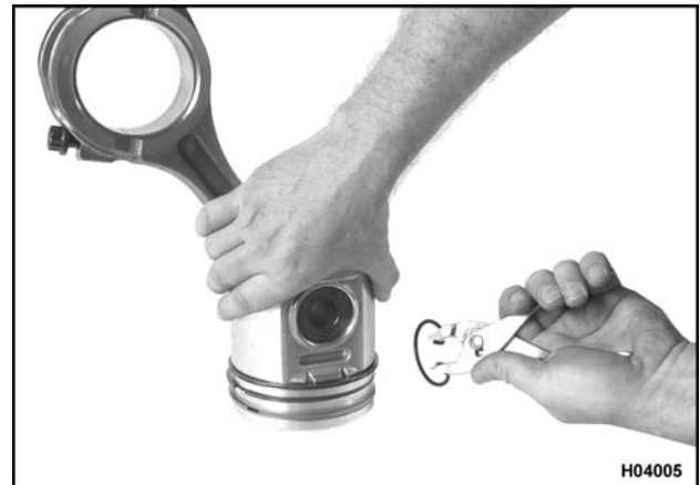
Figura 316 Instalación de los anillos de retención
