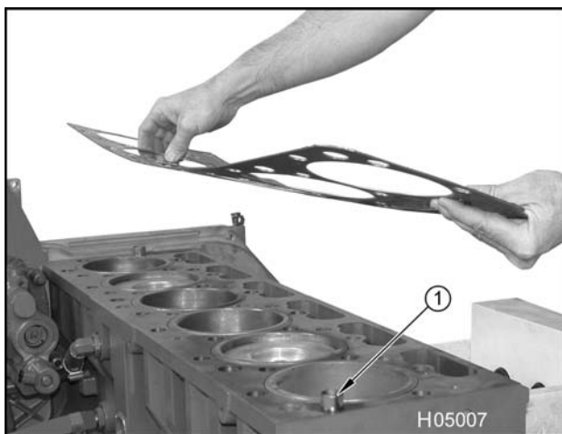
Figura 174 Instalación de la empaquetadura de la culata
