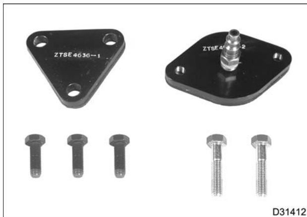
Figura 614 Placas para pruebas de presión del enfriador de EGR, ZTSE4636
