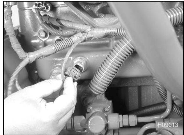
Figura 481 Conexión al MAT
