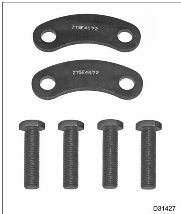
Figura 629 Sujetadores para protuberancia de camisas, ZTSE4672
