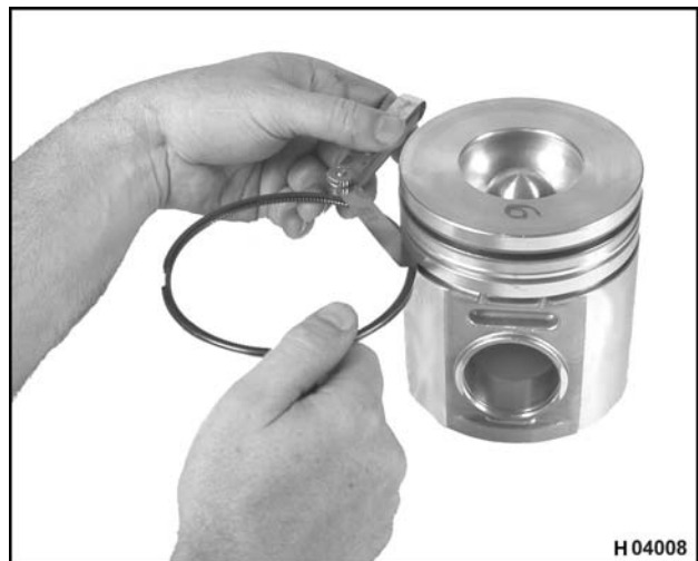
Figura 287 Medición del juego lateral del anillo de control de aceite en su ranura
