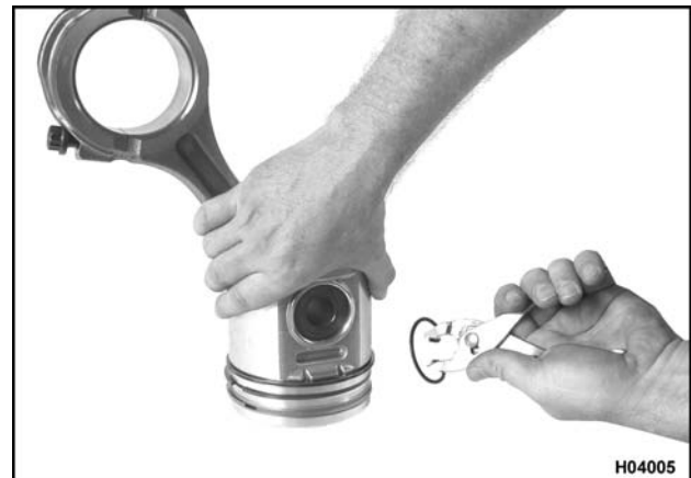
Figura 281 Retiro de los anillos de retención del pistón
