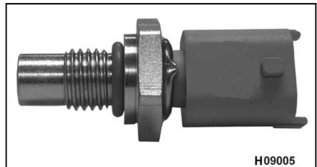
Figura 409 Sensor de temperatura del aceite del motor (EOT) y sensor de temperatura del refrigerante (ECT)
