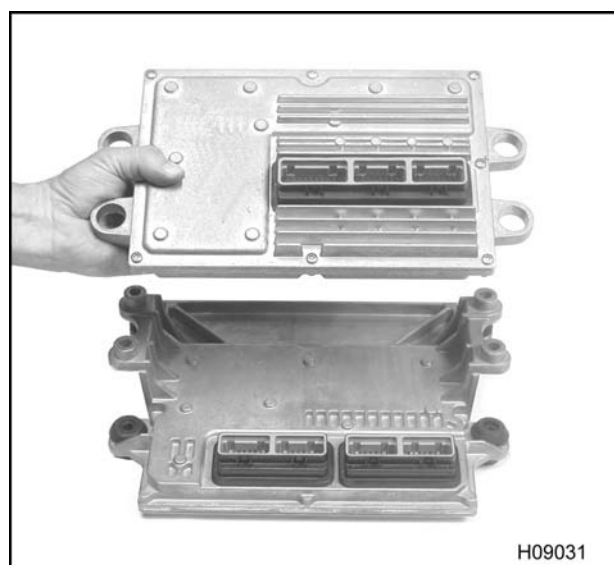
Figura 449 Separación del IDM y el ECM
