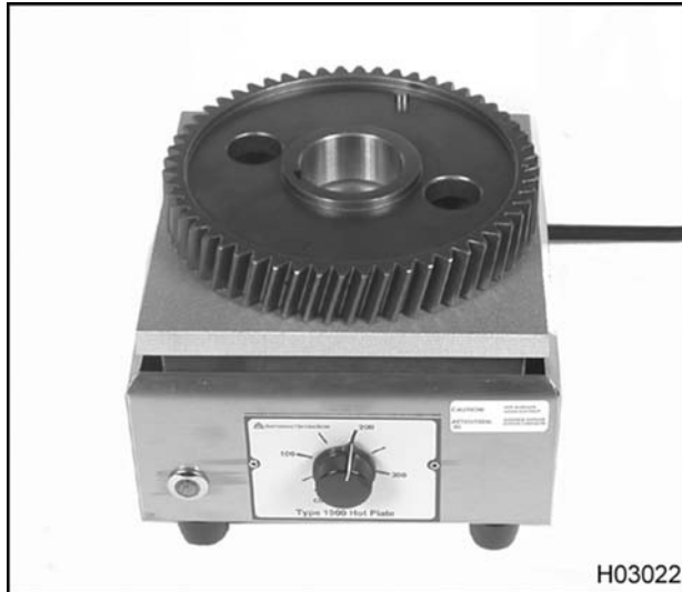
Figura 353 Calentamiento del engranaje del árbol de levas
