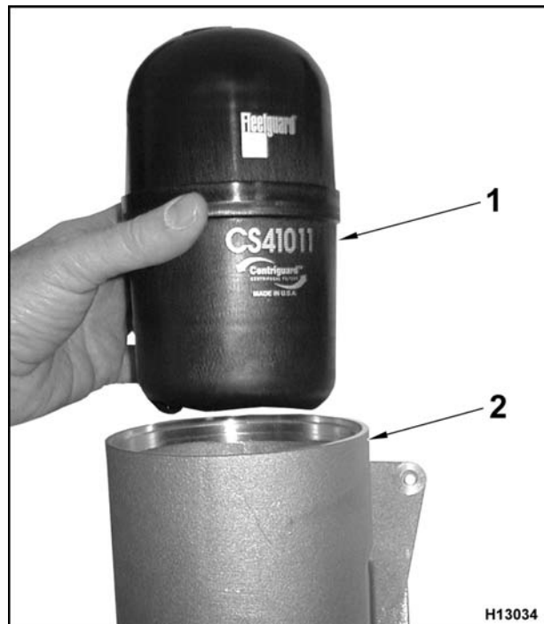
Figura 391 Filtro secundario retirado (opcional)
