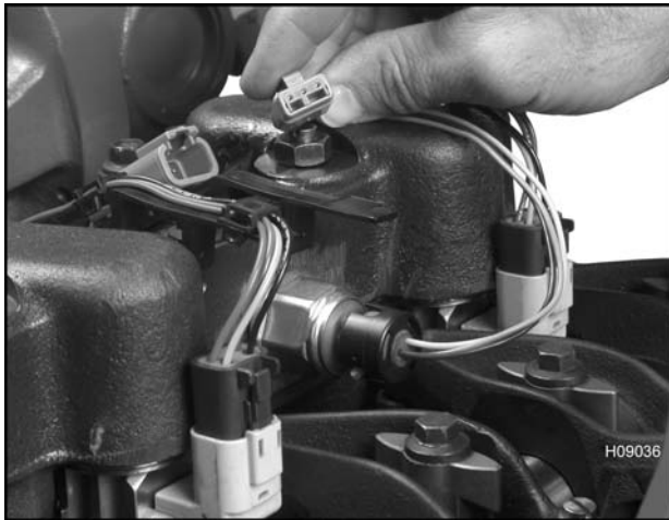
Figura 603 Conector eléctrico del BCP
