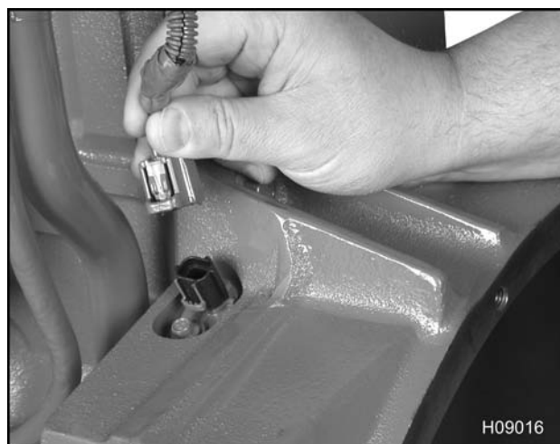
Figura 433 Desconexión del CKP
