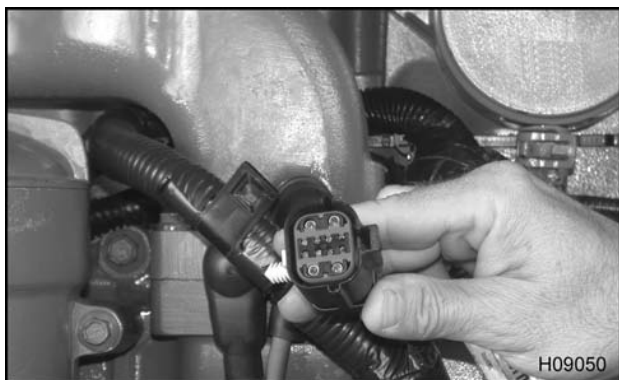
Figura 435 Conector de 12 cables del motor
