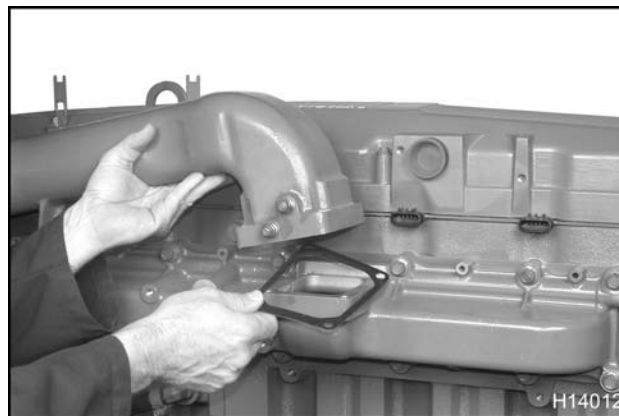
Figura 82 Empaquetadura del mezclador de aire y gases de escape
