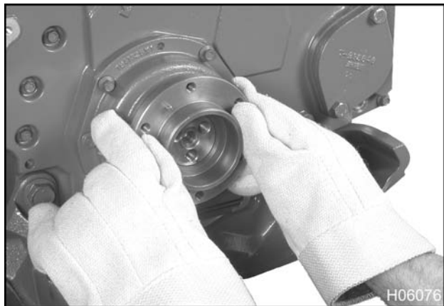
Figura 240 Instalación del amortiguador de vibraciones
