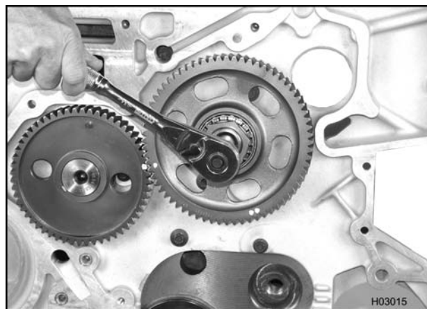
Figura 217 Retiro del engranaje libre superior
