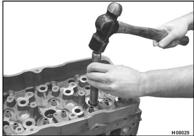
Figura 170 Instalación de la camisa
