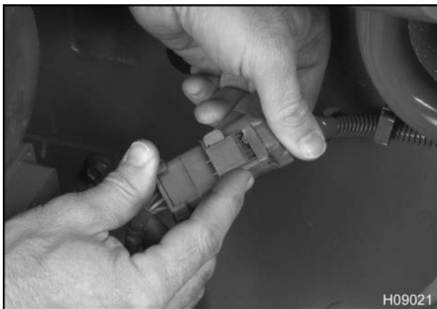
Figura 419 Desconexión del conector del VGT
