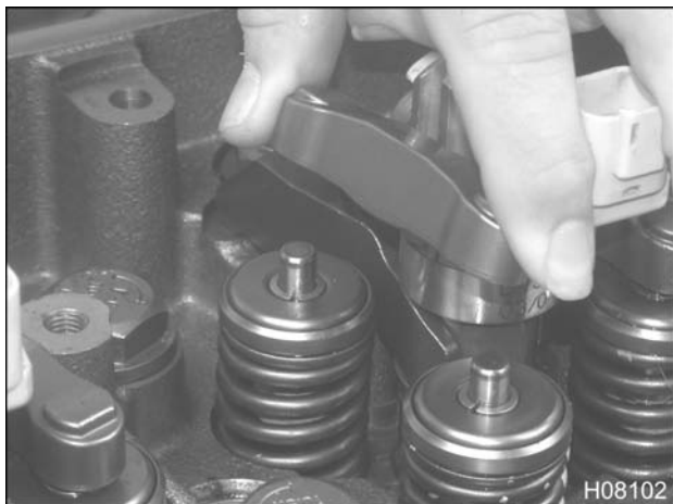
Figura 118 Retiro de los puentes de válvula
