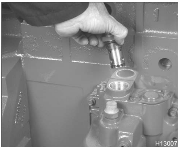
Figura 383 Retiro de la válvula reguladora
