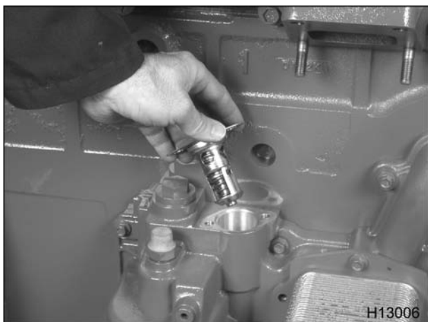
Figura 398 Instalación de la válvula térmica de aceite
