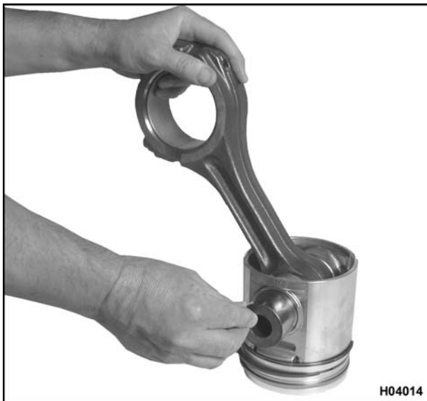
Figura 315 Instalación del pasador del pistón
