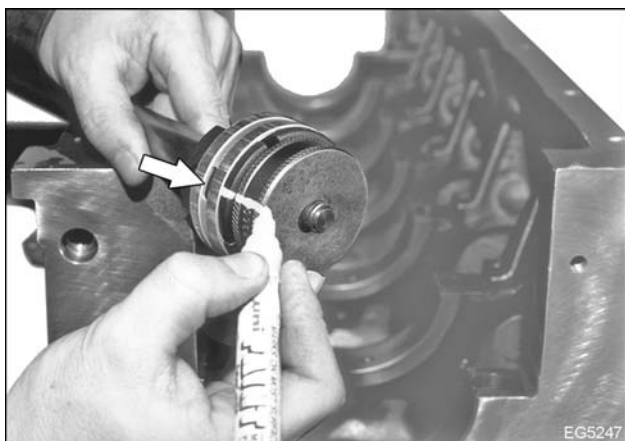
Figura 347 Marca en la ubicación del orificio de aceite del buje
