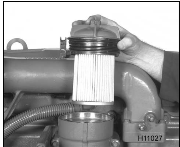
Figura 544 Elemento filtrante del filtro de combustible
