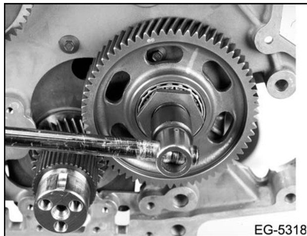
Figura 216 Retiro del engranaje libre inferior
