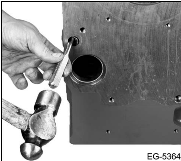
Figura 343 Retiro de los tapones del bloque del motor
