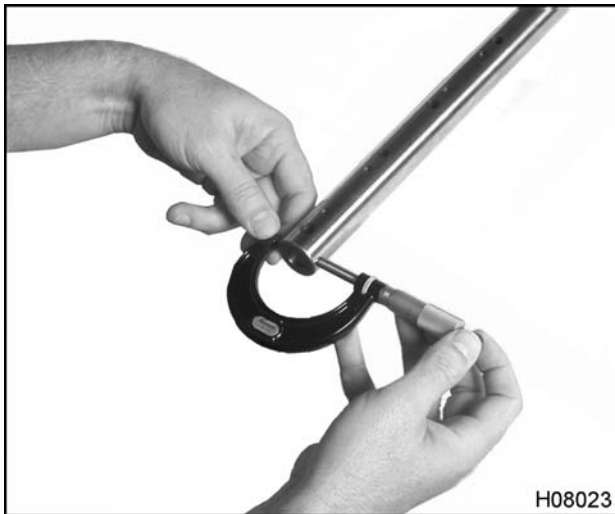
Figura 128 Medición del eje de balancines
