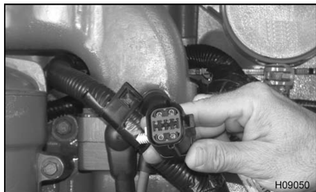
Figura 472 Conector de 12 cables del motor
