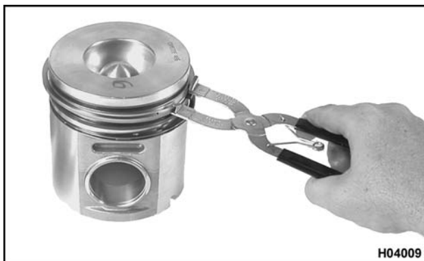
Figura 284 Retiro de los anillos del pistón (se muestra un pistón del motor DT 466)
