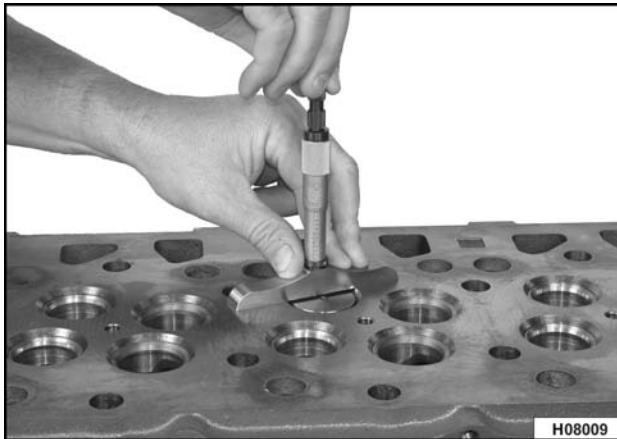
Figura 156 Medición de la recesión de la válvula
