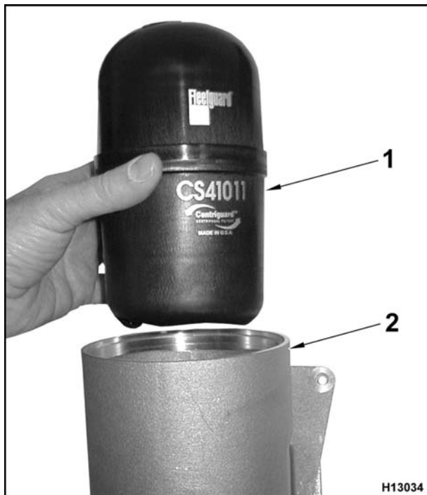
Figura 401 Instalación del filtro secundario (opcional)
