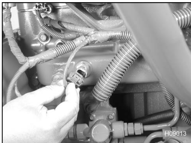
Figura 426 Desconexión del MAT
