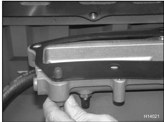
Figura 80 Alineación del múltiple de admisión y la empaquetadura
