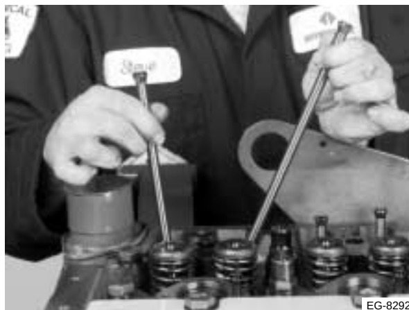
Figura 4.74 Instalación de las varillas de empuje
