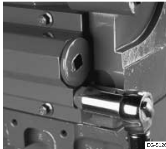
Figura 12.25 Apriete la válvula de retorno de combustible
