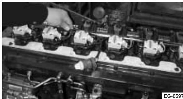
Figura 4.7 Retiro del haz de cables
