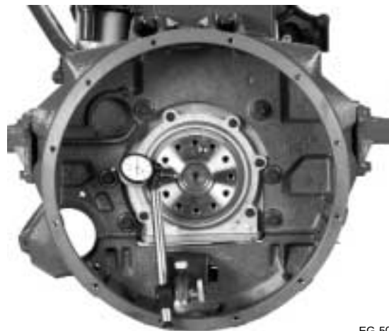
Figura 7.28 Verificación de la concentricidad del eje de guía del cigüeñal
