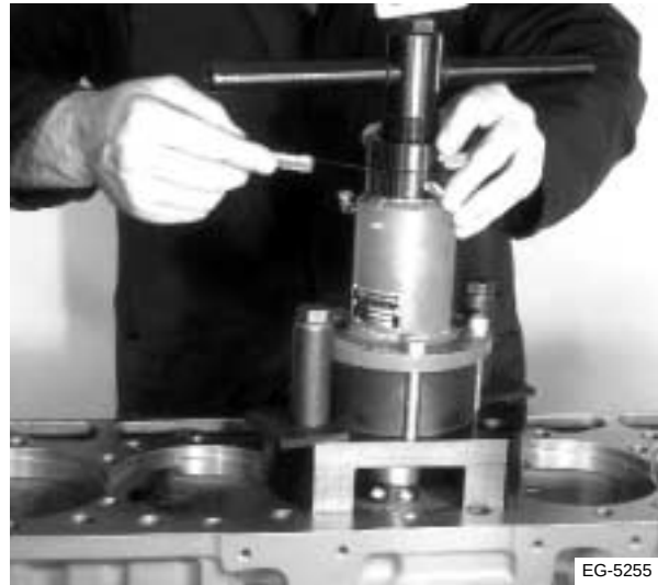
Figura 6.35 Ajuste el cortador de abocardados con láminas calibradas
