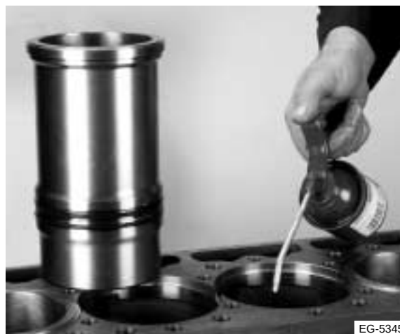
Figura 6.45 Lubrique las cavidades
