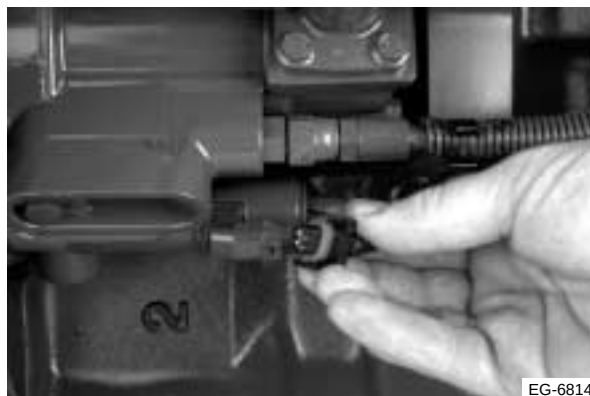
Figura 11.28 Retire el conector del IPR
