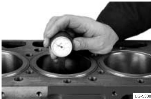
Figura 6.23 Tome la medida debajo del área de recorrido del anillo del pistón con el medidor de diámetros interiores
