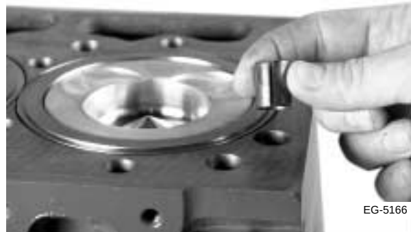
Figura 4.71 Instalación de los anillos de media caña
