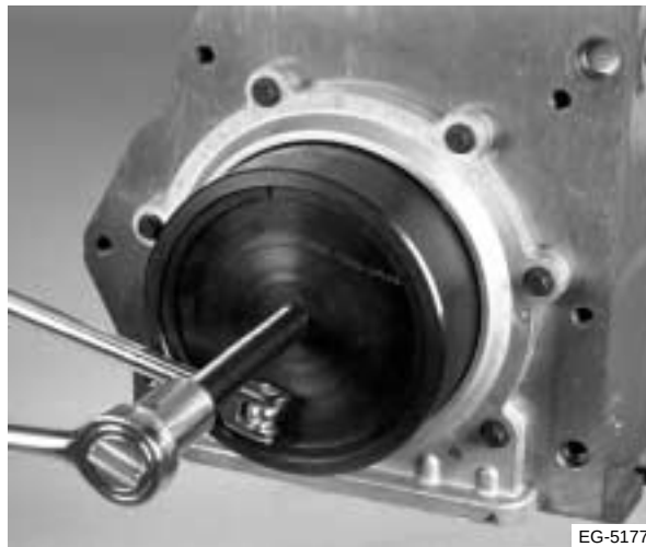
Figura 7.13 Retiro de la camisa de desgaste
