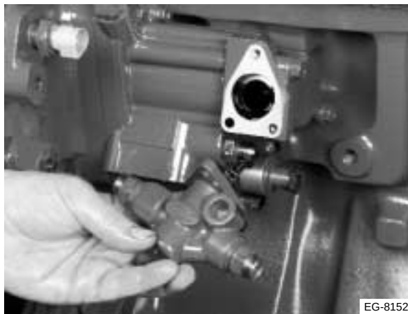
Figura 13.9 Inspección del émbolo de la bomba
