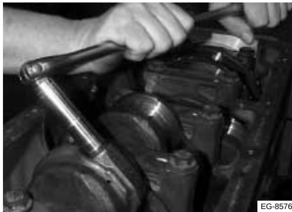
Figura 6.2 Retiro de los pernos de montaje de las bielas
