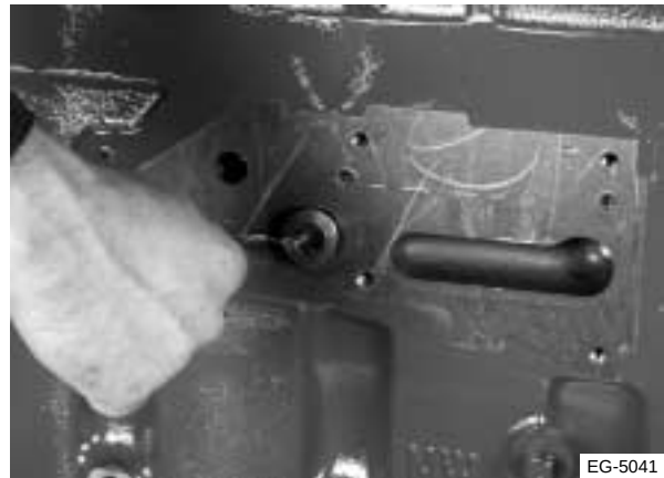
Figura 1.9 Retiro de la válvula reguladora
