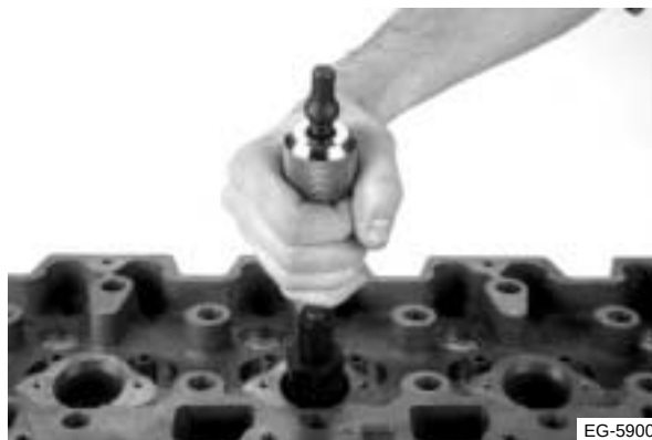
Figura 4.61 Retiro de la camisa
