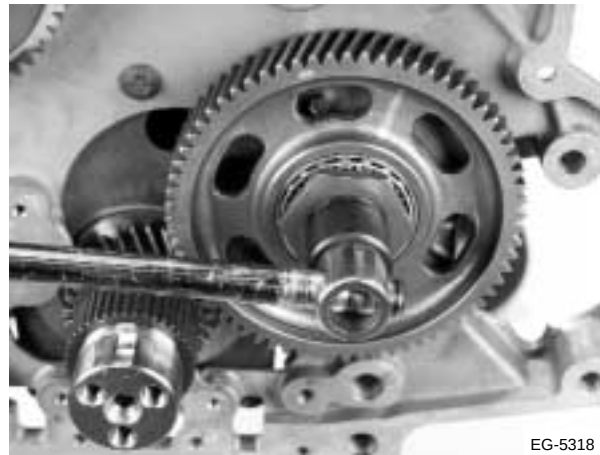
Figura 8.19 Retiro del engranaje libre inferior
