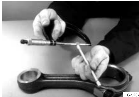
Figura 6.18 Mida la conicidad de las cavidades para los cojinetes
