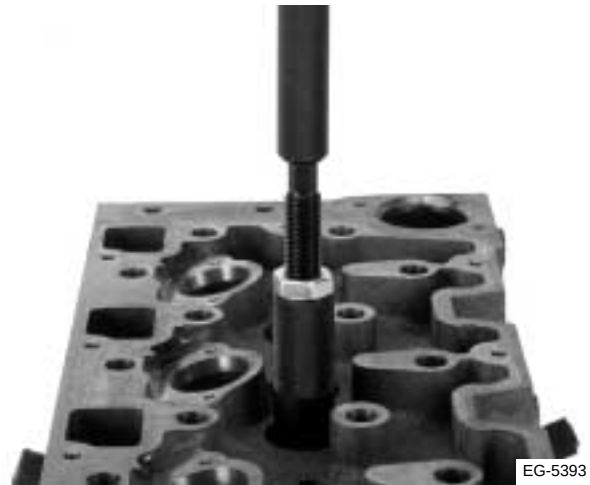
Figura 4.38 Uso del instalador de guías
