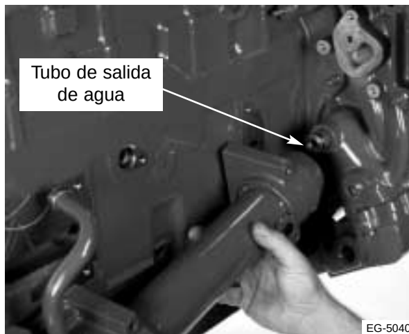
Figura 9.23 Instalación del tubo de salida de agua
