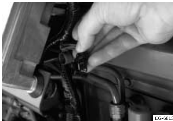
Figura 11.27 Retire el conector del ICP
