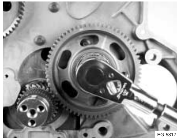
Figura 8.25 Instalación del engranaje libre inferior
