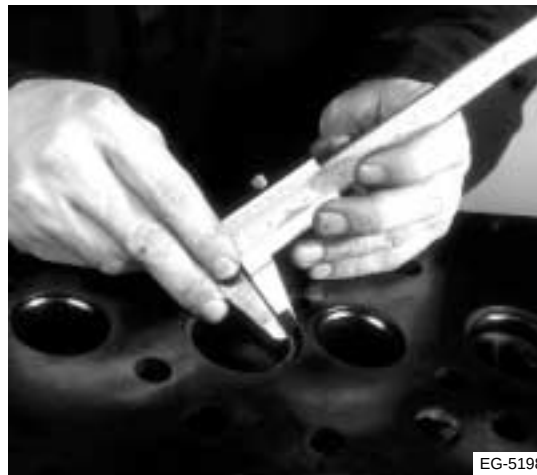
Figura 4.47 Verificación del asiento de la válvula después de esmerilar
