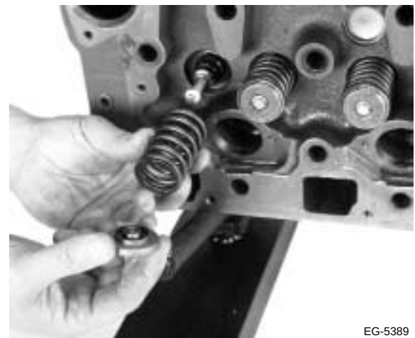
Figura 4.33 Retiro de los componentes de las válvula
