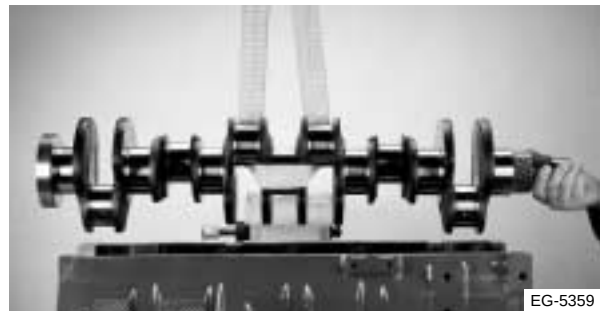
Figura 7.80 Instalación del cigüeñal
