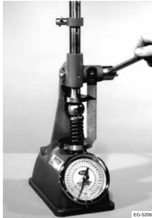
Figura 4.57 Revisión del rotador
