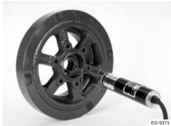
Figura 7.94 Uso del calentador de amortiguador de vibraciones
