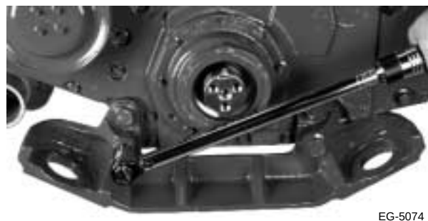
Figura 7.91 Instalación del soporte de montaje delantero
