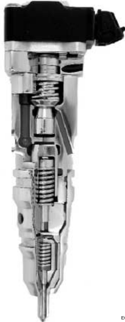
Figura i.19 Ciclo de vaciado del inyector
