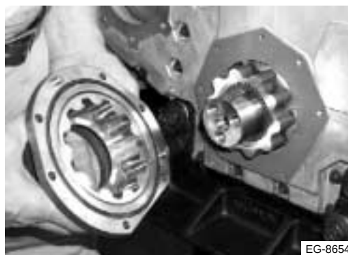
Figura 9.14 Instalación de la caja protectora de la bomba de aceite
