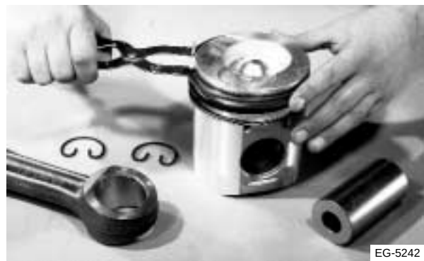
Figura 6.10 Retiro de los anillos
