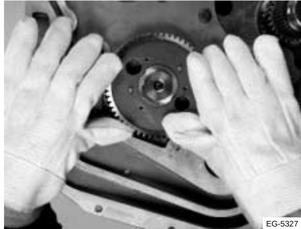
Figura 5.26 Instalación del engranaje en el árbol de levas
