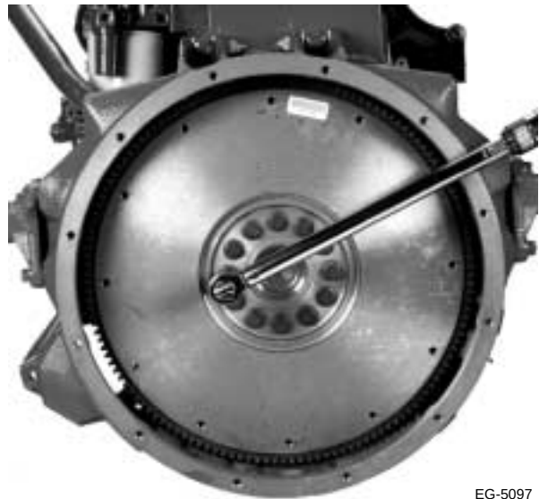
Figura 7.30 Instalación del volante
