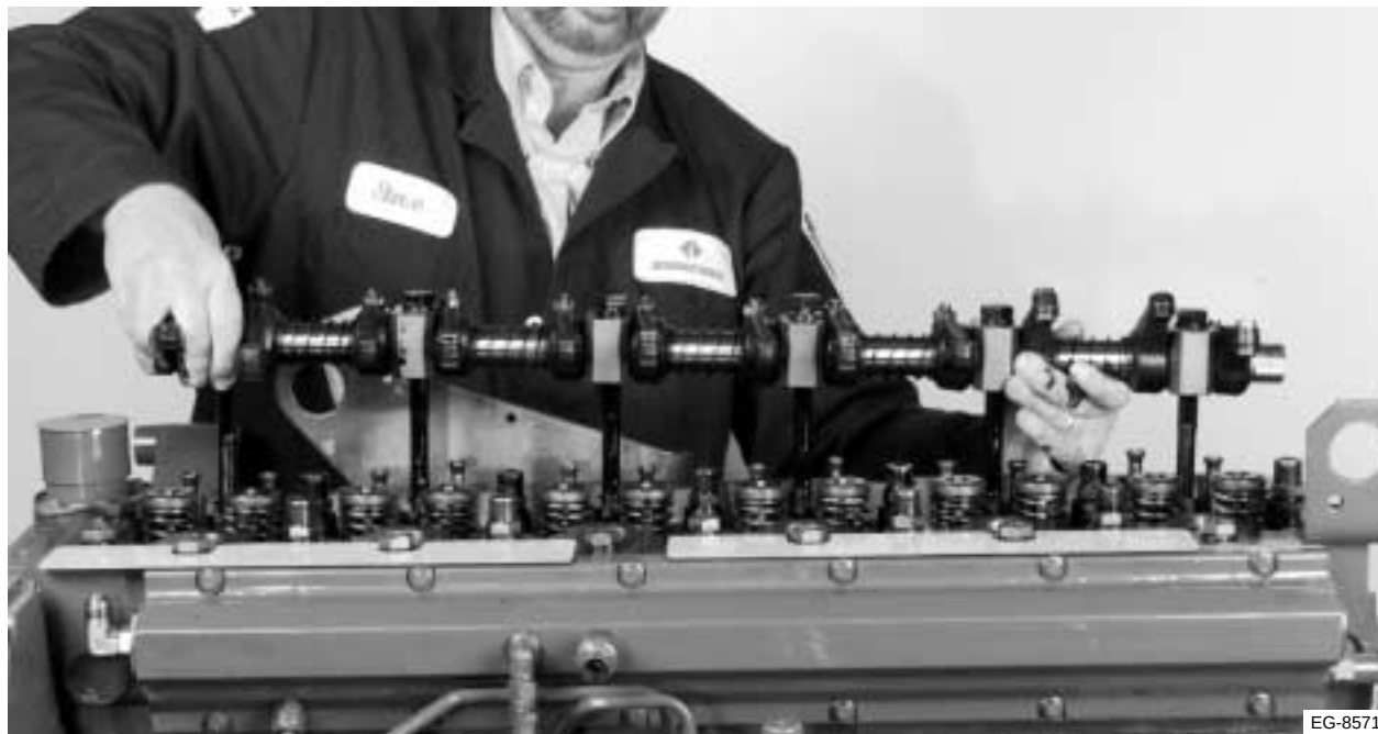
Figura 4.19 Retiro de los balancines
