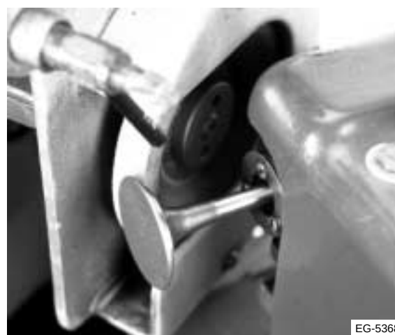
Figura 4.41 Rectificación de la cara de la válvula
