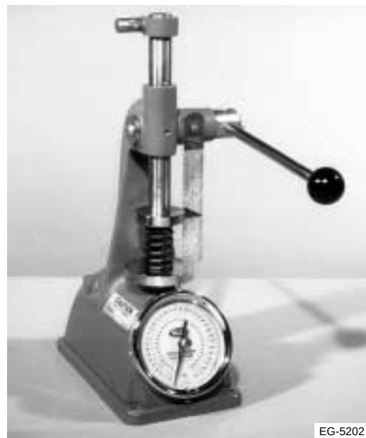
Figura 4.56 Revisión de la tensión de los resortes
