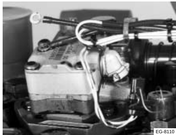
Figura 4.5 Retire el retenedor de alambre
