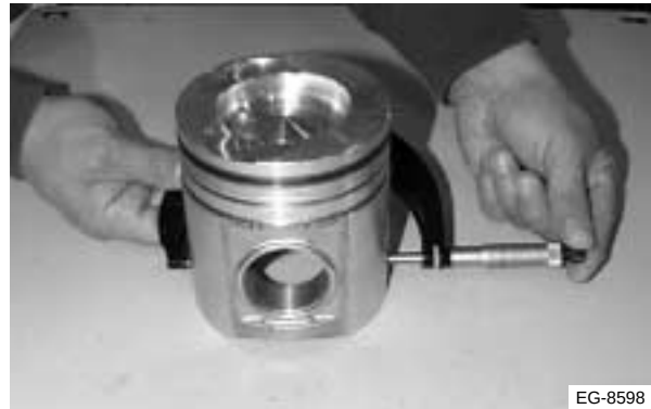
Figura 6.14 Mida el diámetro de la falda de cada pistón
