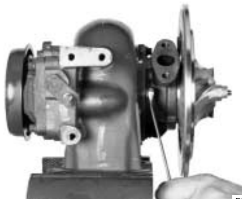
Figura 2.17 Retiro de la caja protectora de la turbina
