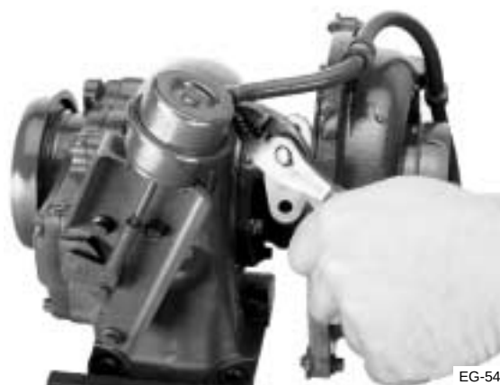
Figura 2.11 Retiro de las abrazaderas
