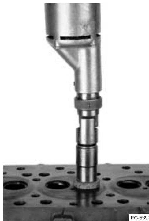
Figura 4.46 Uso del instalador de asientos de válvula ZTSE-4164-A
