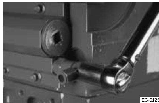
Figura 12.26 Apriete el conector tipo guitarra
