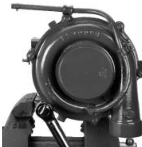
Figura 2.23 Instalación de la caja protectora del compresor
