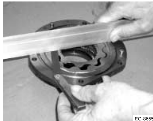
Figura 9.9 Revise el juego entre la caja protectora y el rotor
