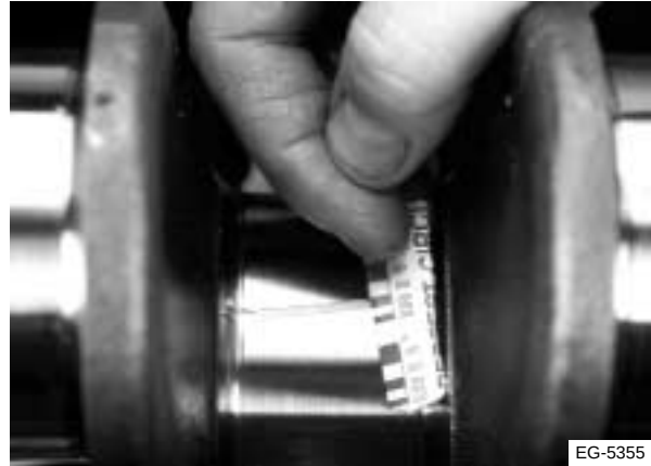
Figura 7.81 Plastigage para medir
