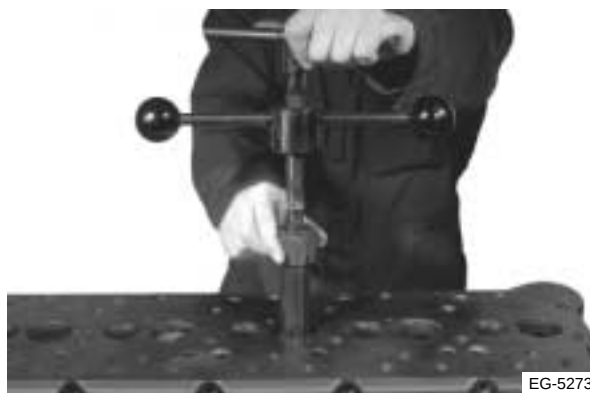
Figura 4.51 Instalación de la boquilla en el asiento de la válvula
