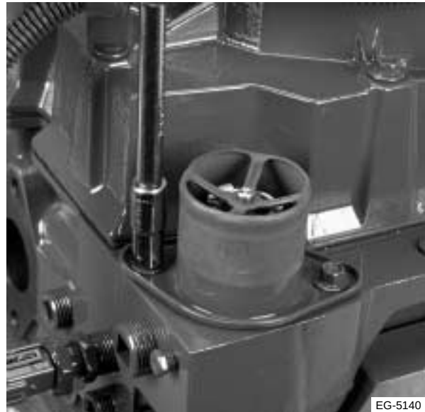
Figura 10.7 Retiro de los pernos de montaje del termostato
