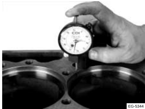
Figura 6.30 Medición de la profundidad de los abocardados con un calibrador de superficies
