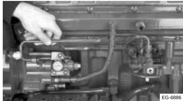
Figura 13.12 Instalación de la tubería de retorno de la bomba
