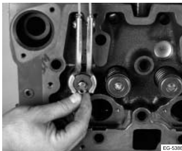
Figura 4.70 Instalación de las trabas
