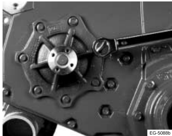
Figura 10.5 Instalación de la bomba de agua
