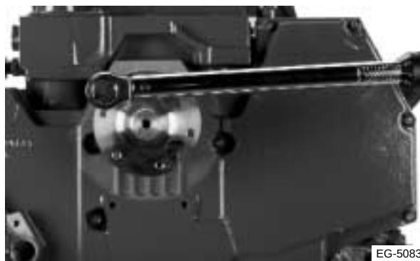
Figura 8.36 Instalación del núcleo impulsor del ventilador
