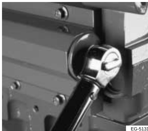
Figura 12.4 Instalación del tapón de extremo
