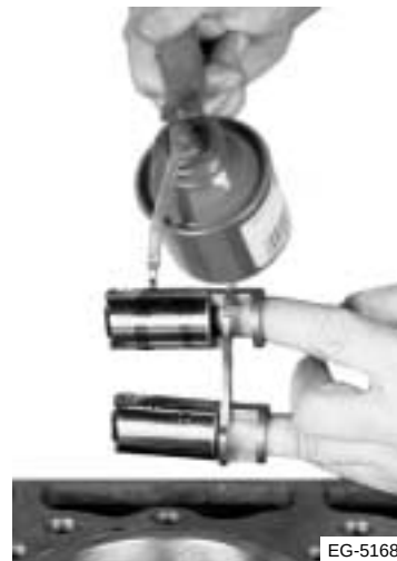
Figura 5.36 Lubrique las guías y los levantaválvulas de rodillo
