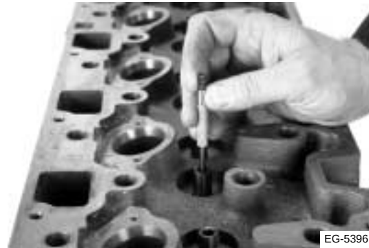
Figura 4.35 Medición de las guías
