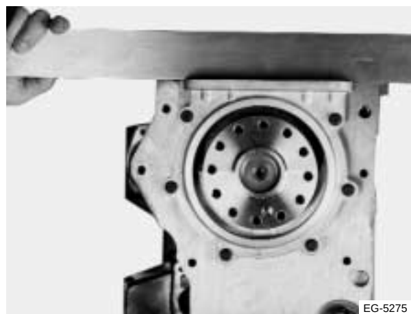
Figura 7.22 Alineación del soporte del sello
