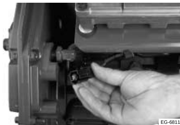
Figura 11.30 Retire el conector del EOT
