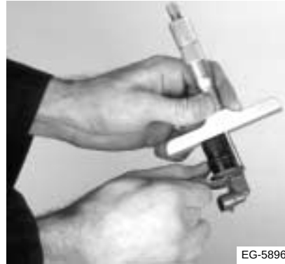
Figura 11.41 Medición del CMP con el micrómetro de profundidad (OEM 1013)
