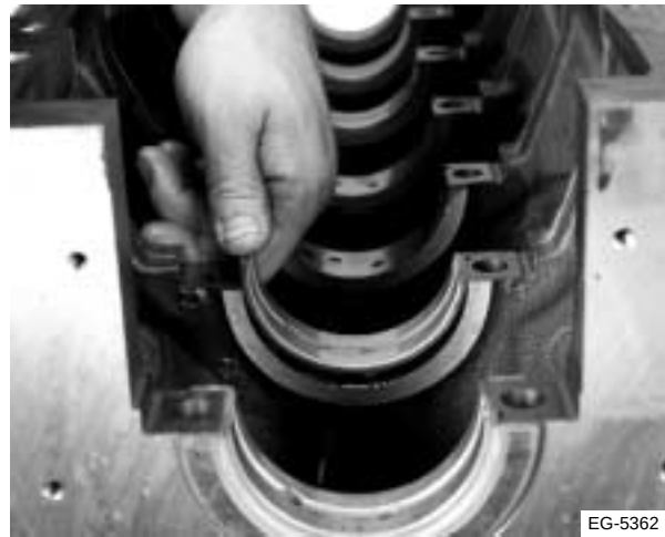
Figura 7.78 Instalación de los casquillos superiores
