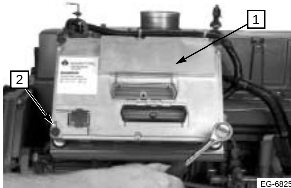
Figura 11.6 ECM instalado en la parte delantera del motor
