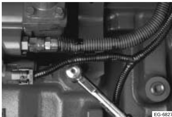
Figura 11.12 Perno inferior del soporte de montaje
