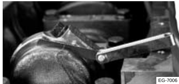
Figura 6.29 Mida el juego entre las bielas y el muñón del cigüeñal
