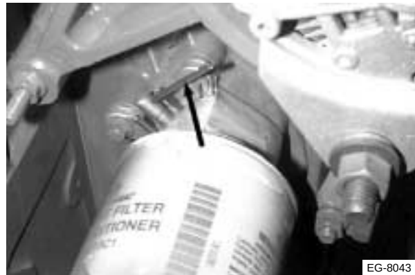
Figura 10.12 Retiro del filtro del refrigerante
