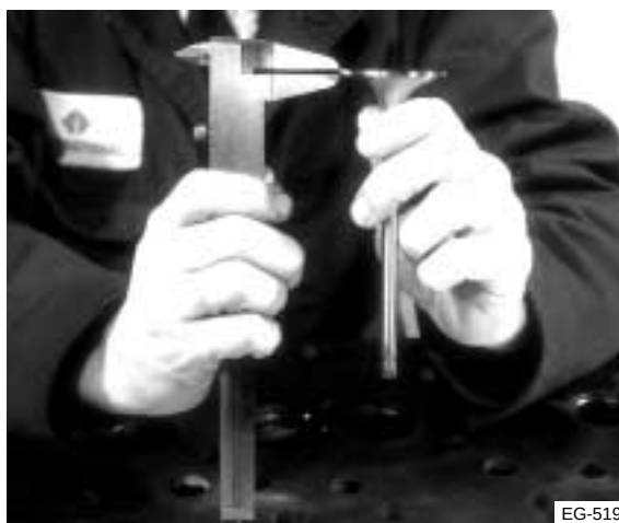
Figura 4.42 Medición del margen de la cara de la válvula
