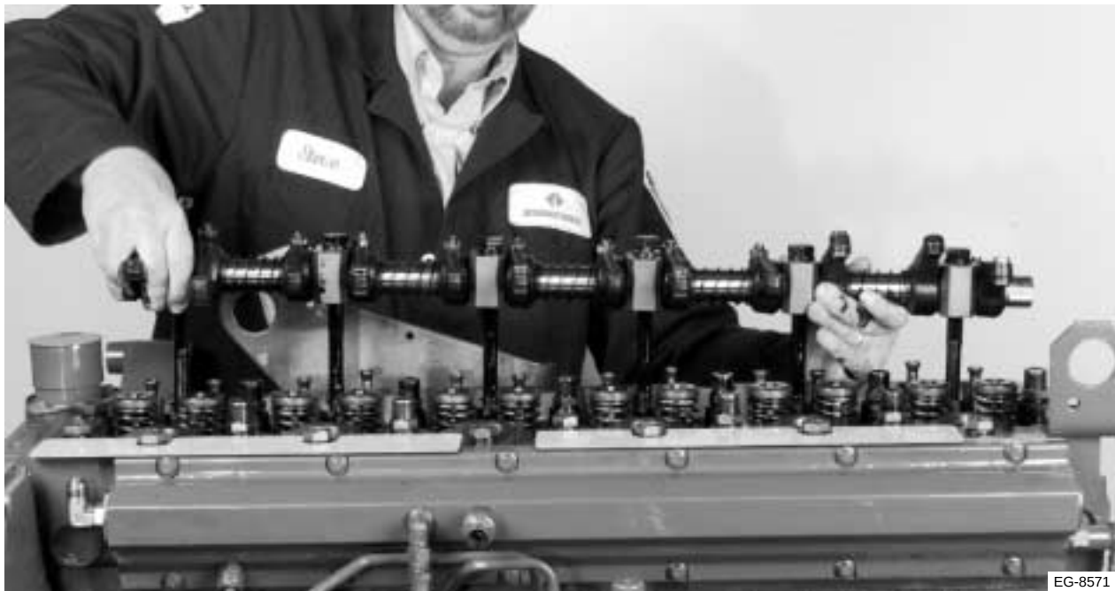
Figura 5.2 Retiro del conjunto de balancines
