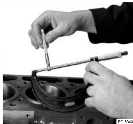
Figura 6.21 Mida el calibrador telescópico con el micrómetro externo
