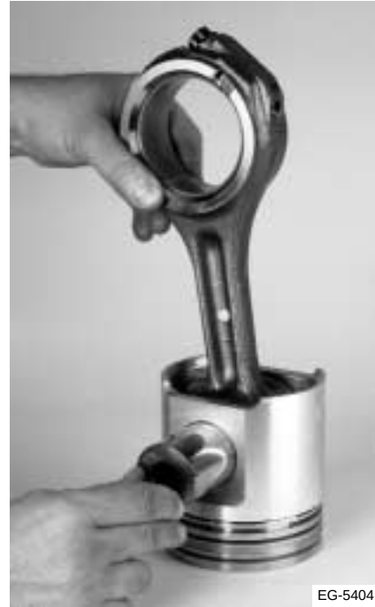
Figura 6.42 Instalación de los pasadores de los pistones
