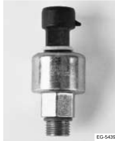
Figura 11.45 Sensor de la presión de control de la inyección
