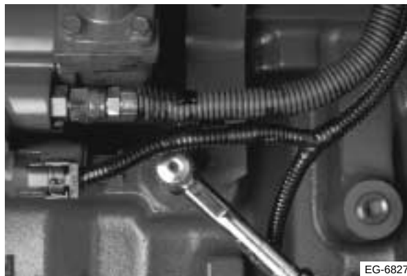
Figura 11.18 Perno inferior del soporte de montaje
