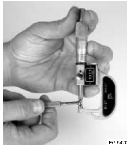
Figura 4.36 Medición del calibre de las guías
