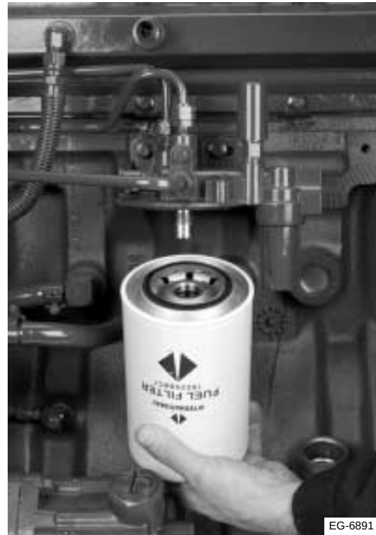
Figura 13.16 Instalación del filtro de combustible
