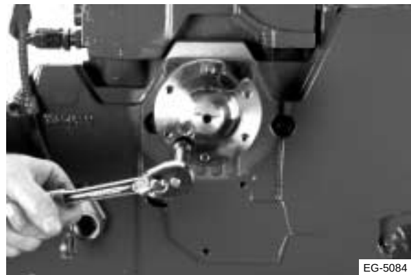
Figura 8.7 Retiro del núcleo impulsor del ventilador
