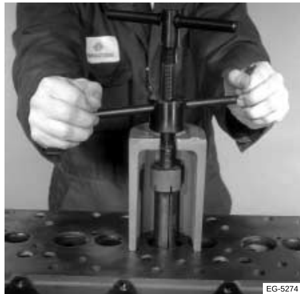
Figura 4.52 Retiro del encastre del asiento
