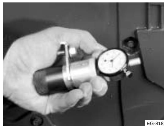
Figura 11.39 Herramienta de medir en taza de calibración
