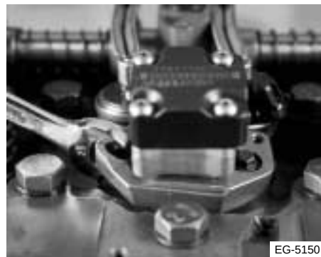
Figura 4.90 Fije la abrazadera de sujeción
