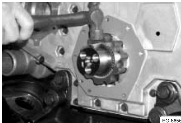
Figura 9.13 Instalación de la chaveta Woodruff
