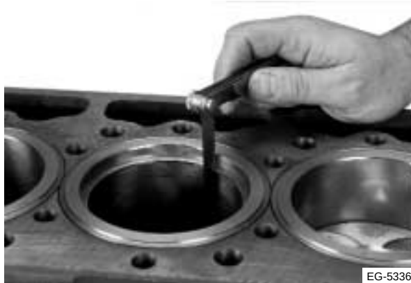
Figura 6.15 Mida la separación de los anillos
