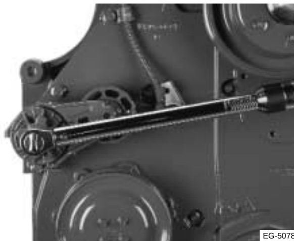
Figura 8.39 Ajuste del tensor automático de la correa al bloque del motor
