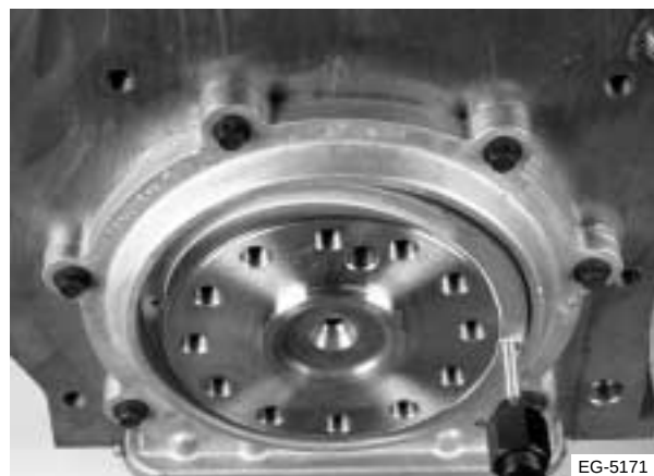
Figura 7.9 Retire del sello de aceite trasero
