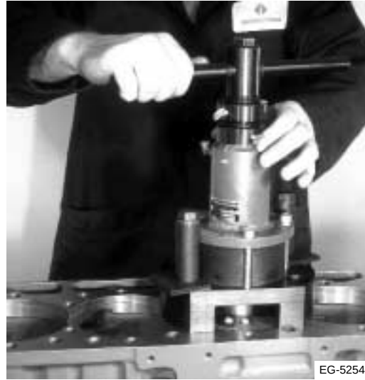
Figura 6.34 Coloque el cortador de abocardados
