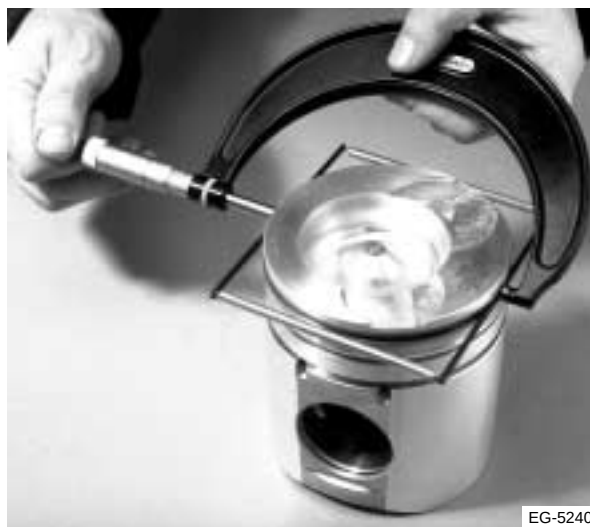
Figura 6.12 Mida el diámetro de cada pistón
