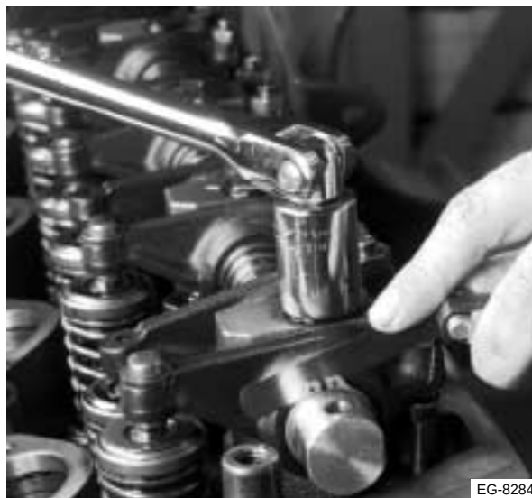
Figura 4.76 Ajuste de los pernos de montaje
