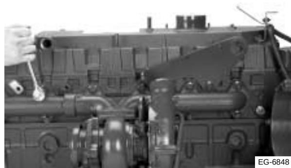
Figura 3.5 Retire el múltiple de escape
