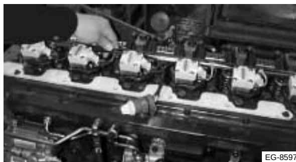
Figura 4.92 Instalación del conducto para cables y deflector de aceite
