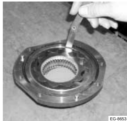
Figura 9.8 Inspección del desgaste de los rotores
