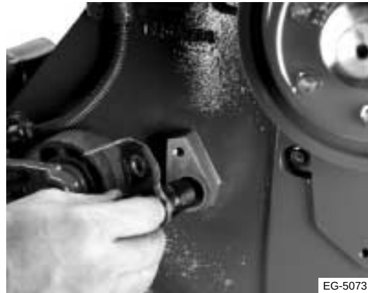
Figura 11.33 Instalación del CMP
