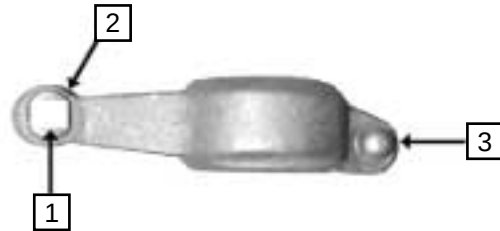
Figura 5.11 Revisión del botón de contacto
