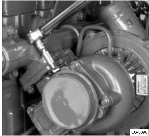
Figura 2.24 Instalación del turboalimentador
