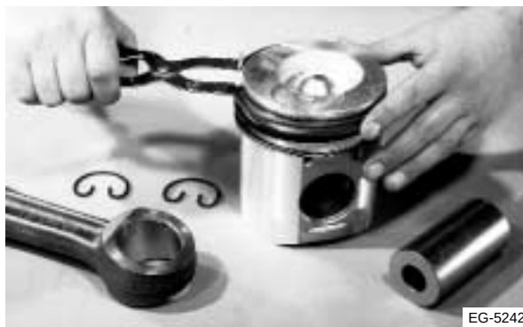
Figura 6.41 Instalación de los anillos (marcas hacia arriba)
