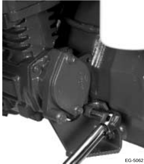
Figura 8.10 Retiro de los pernos del soporte del compresor de aire
