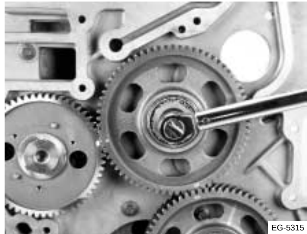
Figura 8.26 Instalación del engranaje libre superior
