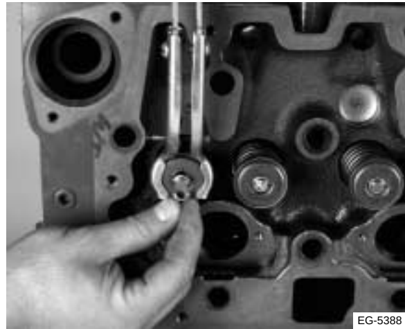
Figura 4.32 Retiro de los retenedores de los resortes
