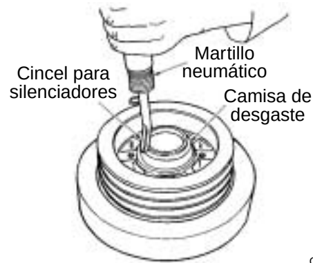
Figura 7.92 Retiro de la camisa de desgaste fuera del amortiguador
