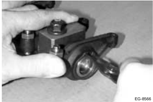
Figura 5.6 Retiro del anillo de retención
