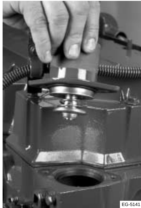
Figura 10.11 Instalación del termostato
