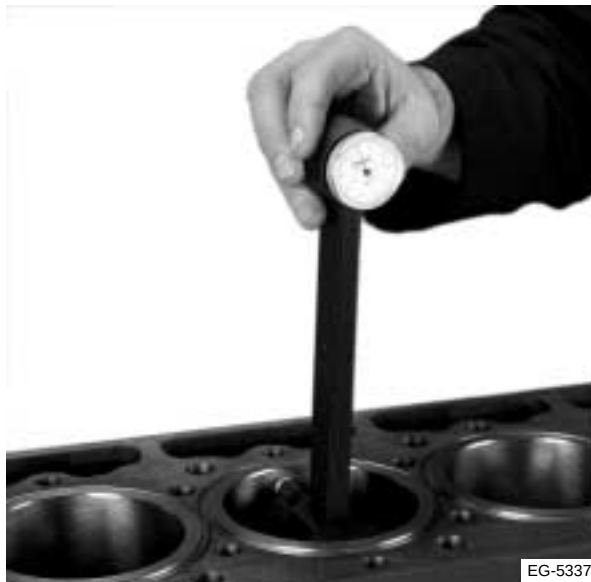
Figura 6.22 Tome la medida en la parte superior del recorrido del anillo del pistón con el medidor de diámetros interiores
