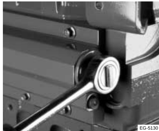
Figura 4.9 Retiro del tapón de extremo
