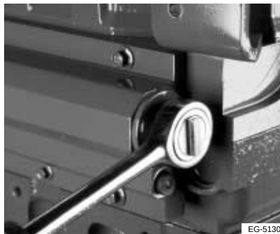
Figura 12.2 Retiro del tapón de extremo
