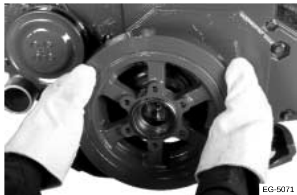
Figura 7.96 Instalación del amortiguador de vibraciones
