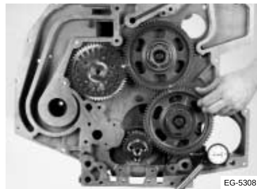
Figura 8.17 Revisión del juego entre dientes del engranaje libre inferior
