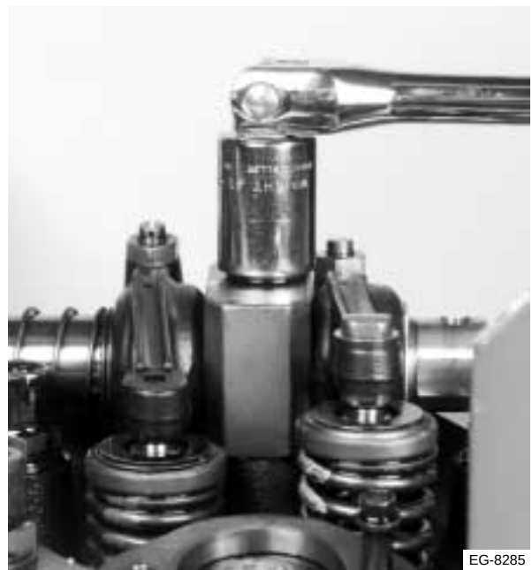
Figura 4.18 Retiro de los pernos de montaje
