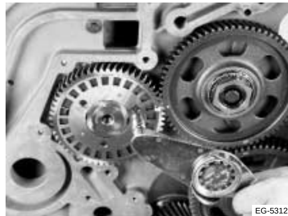
Figura 5.35 Instalación del disco de sincronización
