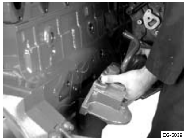
Figura 9.19 Retiro del enfriador de aceite
