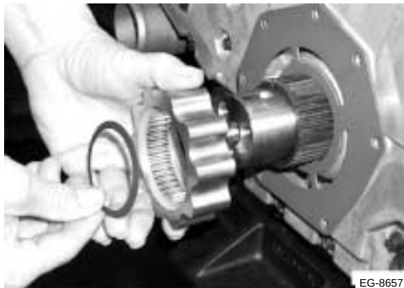
Figura 9.12 Instalación del rotor interior y arandela/sello
