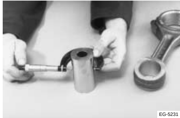
Figura 6.19 Mida el diámetro exterior de los pasadores
