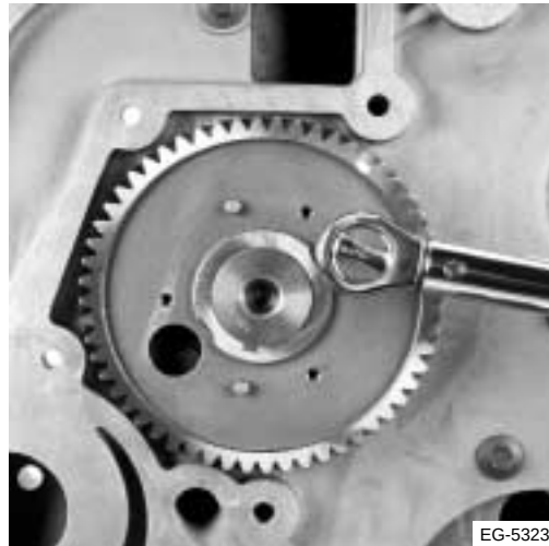
Figura 5.34 Fijación de la placa de empuje
