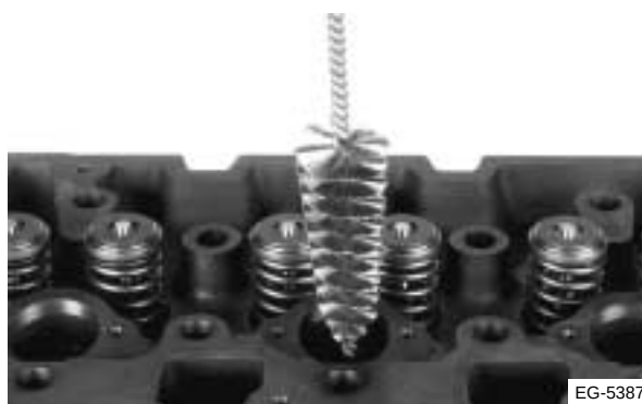
Figura 4.62 Limpieza de la cavidad
