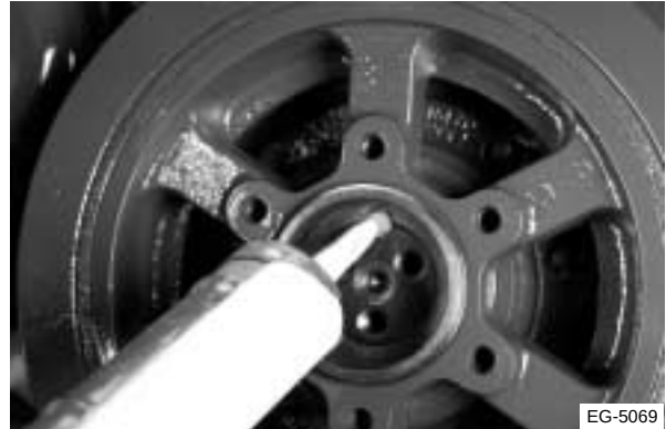
Figura 7.97 Aplicación del RTV al retenedor del amortiguador de vibraciones
