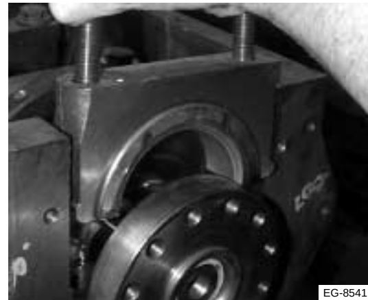
Figura 7.67 Retiro del cojinete trasero de empuje
