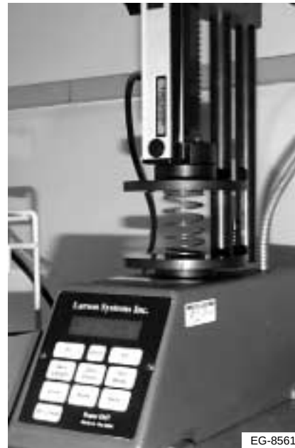
Figura 5.14 Medición de tensión de los resortes
