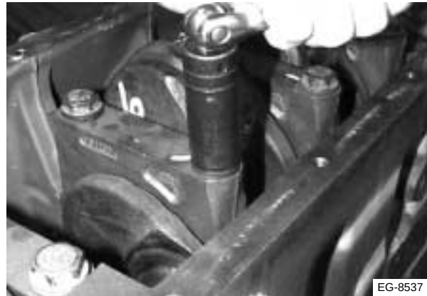
Figura 7.66 Retiro de las tapas de los cojinetes de bancada
