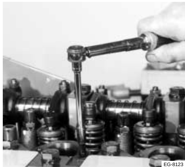
Figura 4.28 Instalación del perno de resalto
