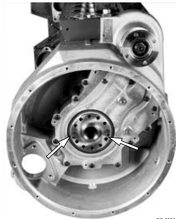
Figura 7.32 Retiro del volante
