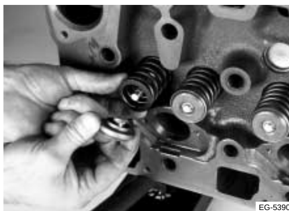
Figura 4.69 Instalación del conjunto rotador
