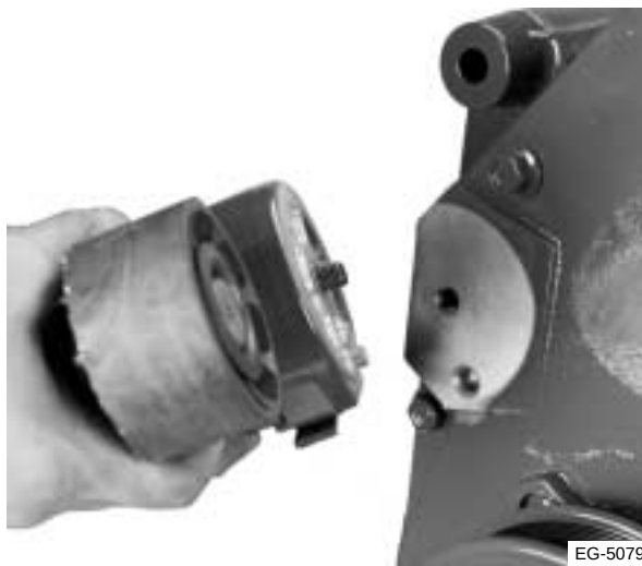
Figura 8.38 Instalación del tensor automático de la correa
