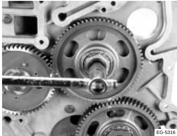
Figura 8.20 Retiro del engranaje libre superior
