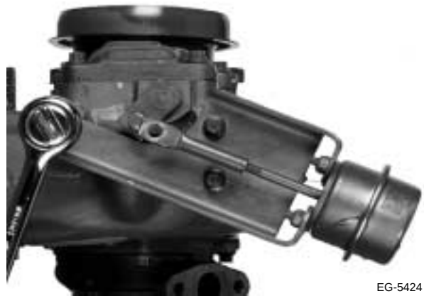
Figura 2.13 Retiro del brazo impulsor de la compuerta de descarga
