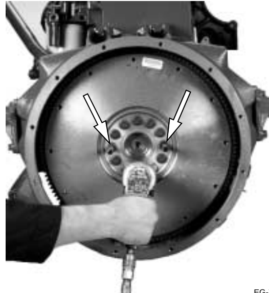
Figura 7.5 Retiro del volante
