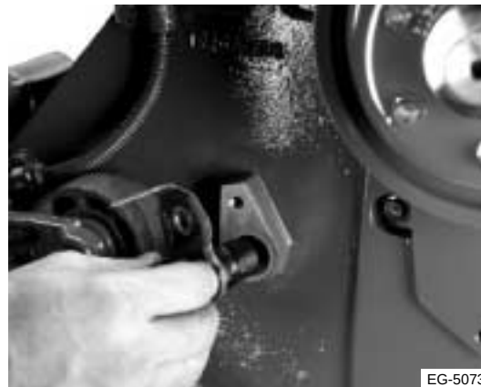
Figura 11.38 Retiro del CMP
