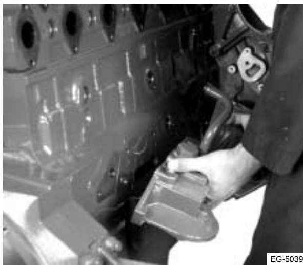
Figura 1.8 Retiro del enfriador de aceite
