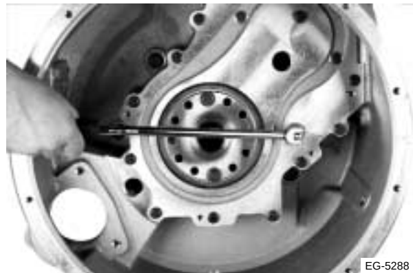
Figura 7.34 Retiro de los tapones roscados
