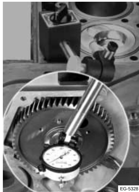
Figura 5.27 Medición del juego longitudinal del árbol de levas
