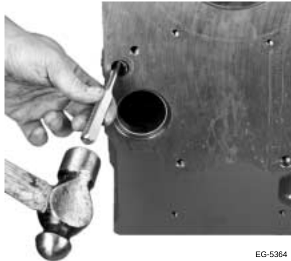
Figura 7.73 Retiro de los tapones del bloque del motor
