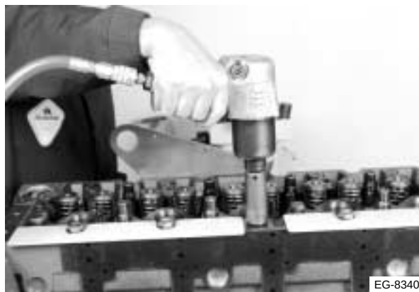
Figura 4.21 Retiro de los pernos de montaje
