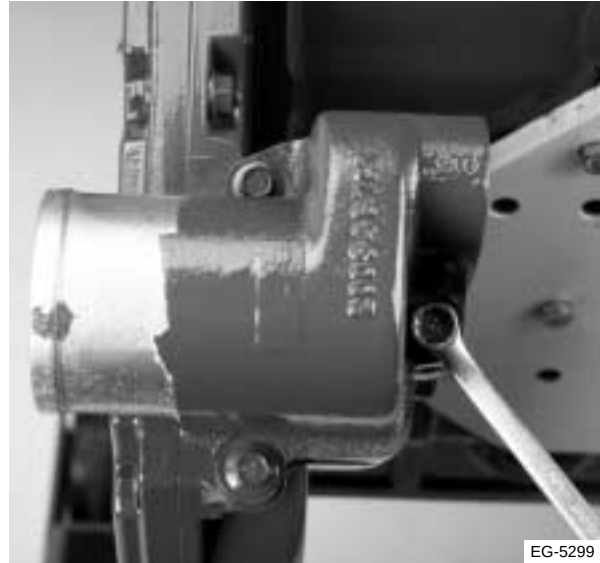
Figura 10.16 Retiro del codo de entrada de agua
