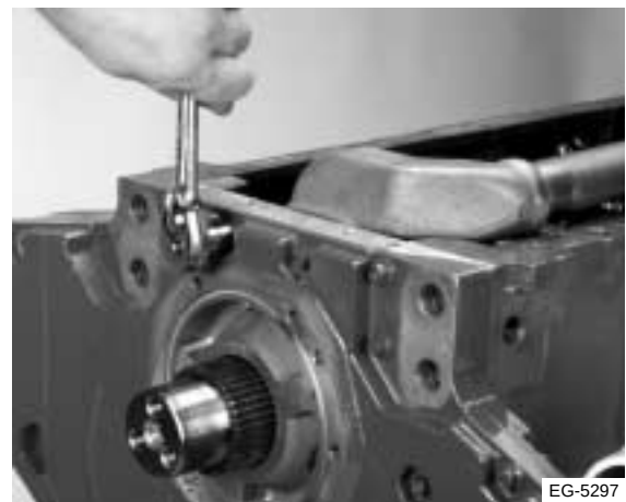
Figura 7.62 Retiro del tubo de captación de aceite
