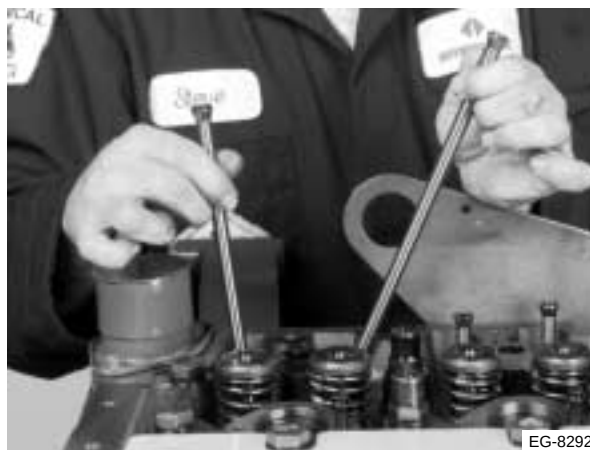
Figura 4.20 Retiro de las varillas de empuje
