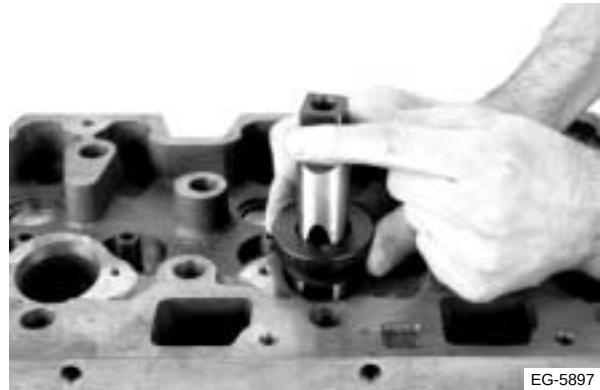
Figura 4.58 Instalación del extractor de camisas
