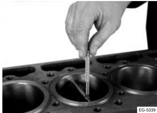
Figura 6.20 Mida el diámetro interior de la camisa
