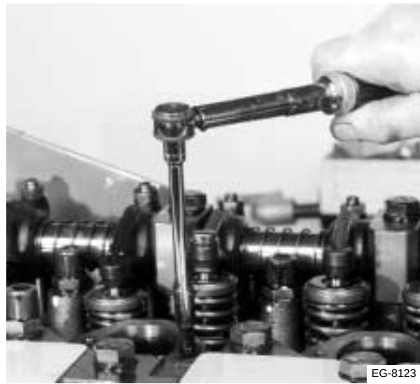
Figura 4.88 Instalación del perno de resalto
