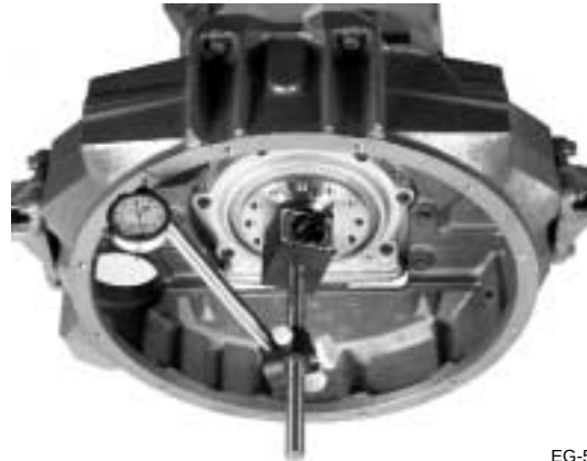
Figura 7.27 Verificación de la desviación de la cara de la caja protectora del volante
