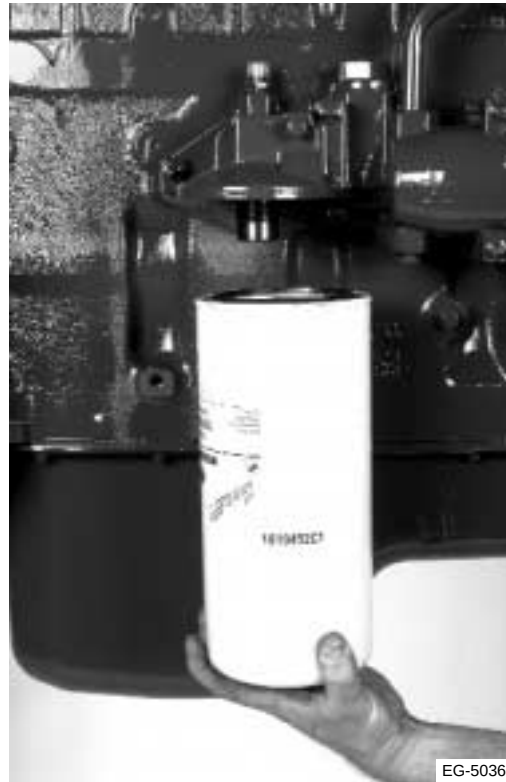
Figura 9.25 Instalación del filtro de aceite
