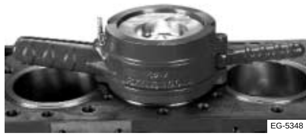
Figura 6.47 Instalación del compresor de anillos
