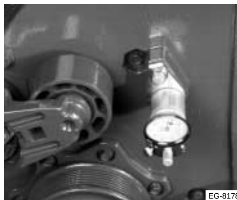
Figura 11.40 Medición de la holgura del CMP
