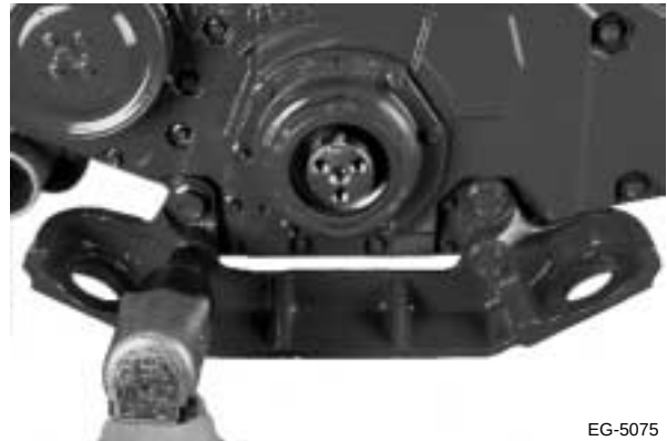
Figura 7.61 Retiro del soporte de montaje delantero del motor
