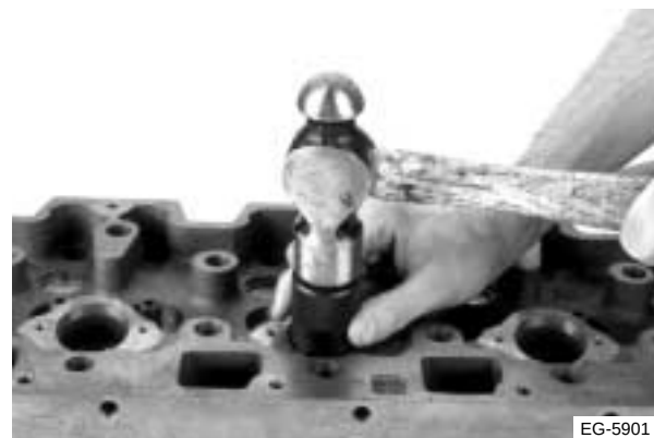
Figura 4.65 Instalación de la camisa
