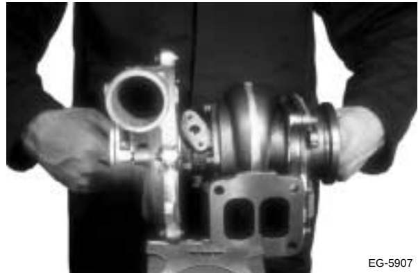
Figura 2.8 Revisión por rozamiento en las cajas protectoras de la turbina y compresor
