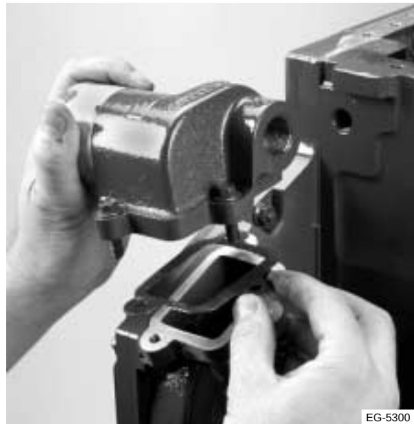
Figura 10.17 Instalación del codo de entrada de agua
