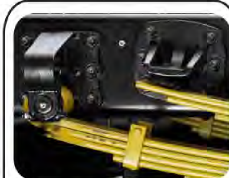
Dudukan & Penahan PER Model Cor Lebih kuat & tidak mudah patah
