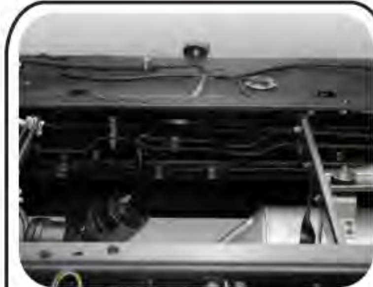
Chassis Tebal 6 mm & Straight Frames Lebih kuat & tahan lama
