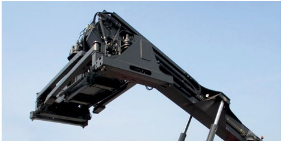
La pluma apenas requiere mantenimiento gracias a las placas deslizantes que no necesitan lubricación.
