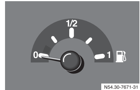
Indicador del nivel del combustible
