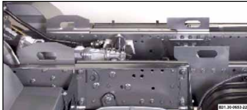
Suporte atrás da cabina
