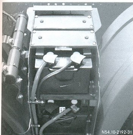
Каркас аккумуляторных батарей сбоку на шасси – аккумуляторные батареи расположены друг над другом (пример)
