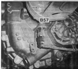
Снятие и установка датчика частоты вращения выходного вала: B57 датчик частоты вращения выходного вала коробки передач
