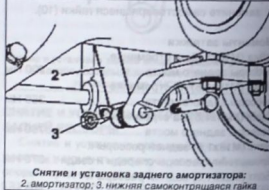
Снятие и установка заднего амортизатора: 2. амортизатор; 3. нижняя самоконтрящаяся гайка
