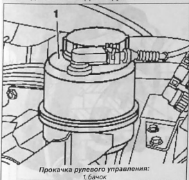
Прокачка рулевого управления: 1. бачок
