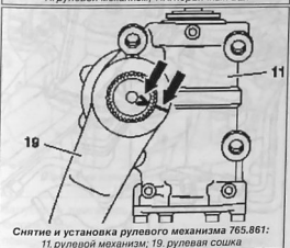
Снятие и установка рулевого механизма 765.861: 11 рулевой механизм; 19, рулевая сошка
