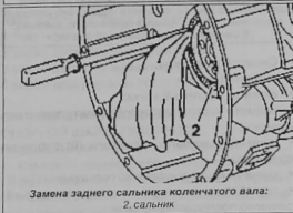
Замена заднего сальника коленчатого вала: 1. маховик, 2. сальник
