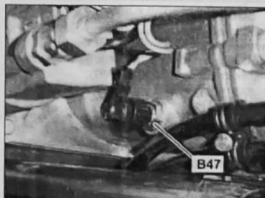
Снятие и установка датчика температуры масла коробки передач: B47 датчик температуры трансмиссионного масла
