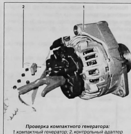
Проверка компактного генератора: 1. компактный генератор; 2. контрольный адаптер
