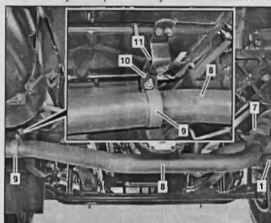
Снятие и установка глушителя на автомобилях с кодом KA2: 1. глушитель; 7. хомут; 8. концевая секция трубы выпуска отработавших газов; 9. хомут; 10. кронштейн; 11. резиновый буфер
