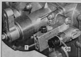
С блокировкой включения механизма отбора мощности: 1 блокировка включения; S9 датчик нейтрального положения
