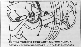
Датчик частоты вращения заднего колеса: 1 датчик частоты вращения; 2 втулка; 3 крышка
