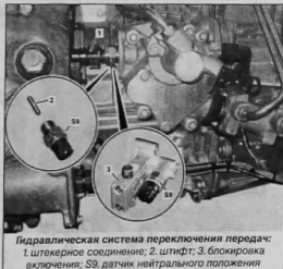
Без блокировки включения механизма отбора мощности: S9 датчик нейтрального положения
