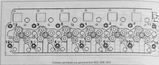
Схема затяжки на двигателях 902, 906, 926
