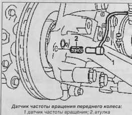
Датчик частоты вращения переднего колеса: 1 датчик частоты вращения; 2 втулка
