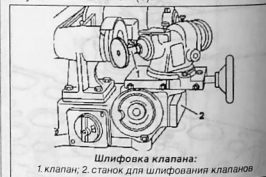
Шлифовка клапана: 1. клапан; 2. станок для шлифования клапанов
