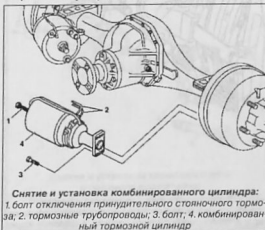
Снятие и установка комбинированного цилиндра: 1. гайки; 2. комбинированный тормозной цилиндр; 3. болт отключения принудительного стояночного тормоза; 4. пневматический трубопровод; 5. шаровая чашка
