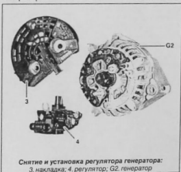
Снятие и установка регулятора генератора: 3. накладка; 4. регулятор; G2. генератор
