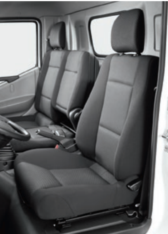
SITZ MIT EINSTELLBARER KOPFSTÜTZE und integrierter Sitzheizung. Bei niedrigen Temperaturen wird der Sitz in wenigen Minuten elektrisch beheizt.
