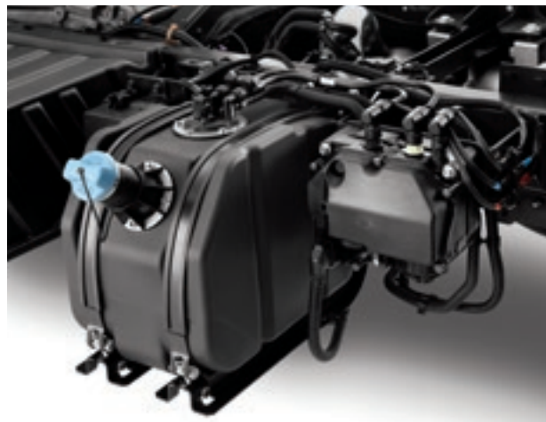
ADBLUE®-TANK auf der Fahrerseite, mit 17,5 l Fassungsvermögen für eine Reichweite von bis zu 8000 km.
