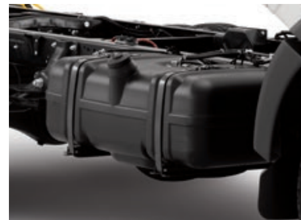
90 L FASSUNGSVERMÖGEN des Treibstofftanks für maximale Reichweite.
