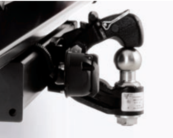
ANHÄNGERKUPPLUNG* für zusätzliche Anhängelasten bis zu einem Gesamtzuggewicht von maximal 8 t.
