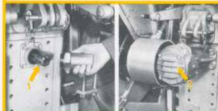
1. Prise de force arrière. 2. Poulie de battage (sur demande).
