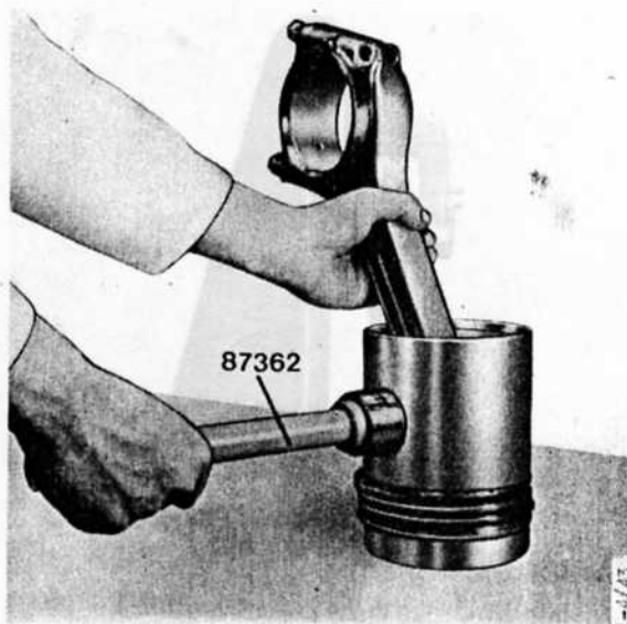
Fig. 88. Montaje del pistón en la biela
