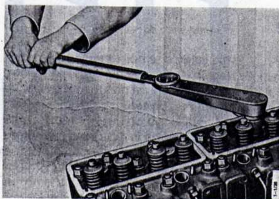
Fig. 39. Se empleará siempre una llave dinamométrica
