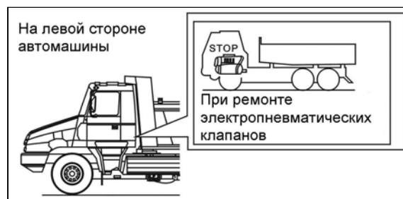
Рис. 0.6 Ремонт электромагнитических клапанов
