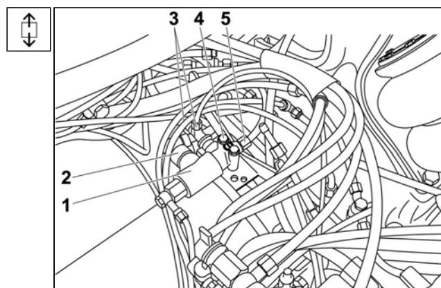
Рис. 9.89 Выпускной электроклапан баллонов – снятие
