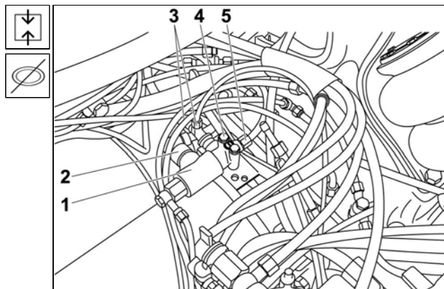
Рис. 9.90 Выпускной электроклапан баллонов – монтаж
