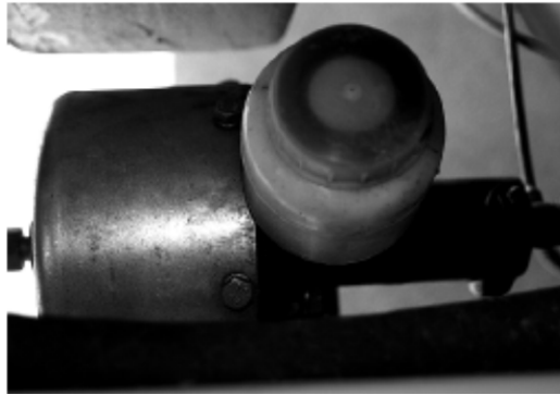
Fig. 5-9 Posición de vasos de aceite de freno
