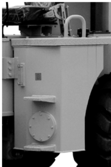
Fig. 5-8 Posición de depósito hidráulico
