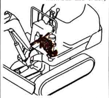
Fig. 48 油圧配管(旋回フレーム: 拡張可変脚仕様) HYD. OIL PIPING (TURNING FRAME: WIDEN/SHORTEN VARIABLE LEG SPEC.)
