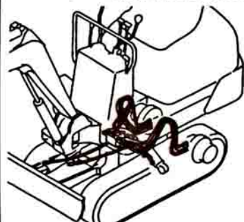
Fig. 52 油圧配管(走行フレーム: 拡張可変脚仕様) HYD. OIL PIPING (DRIVING FRAME: WIDEN/SHORTEN VARIABLE LEG SPEC.)
