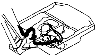
Fig. 86 油圧配管 (バルブ〜モータ〜ブーム) HYD. OIL PIPING (VALVE~MOTOR~BOOM)
