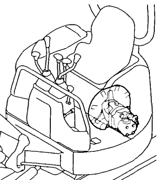
Fig. 28 油圧ポンプ&軸継手 HYD. OIL PUMP & JOINT
