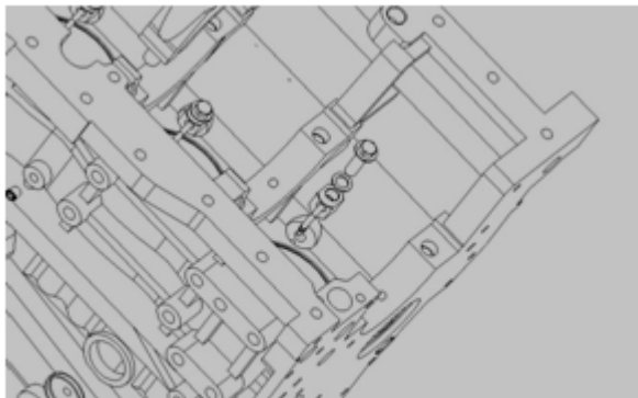
图 2-13 活塞的润滑油冷却喷钩
